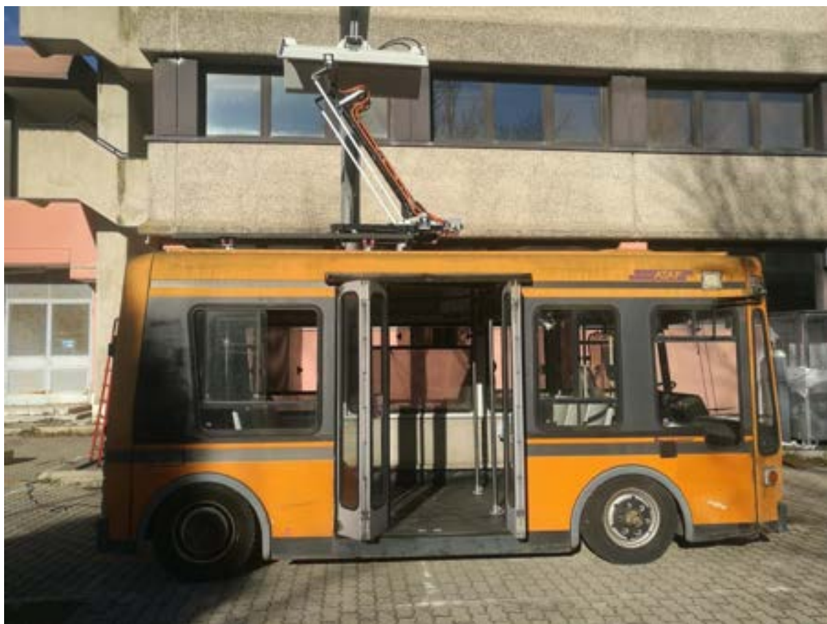
Figura 3. a) Induttore realizzato per la presente sperimentazione b) Pantografo SCHUNK e Bus
