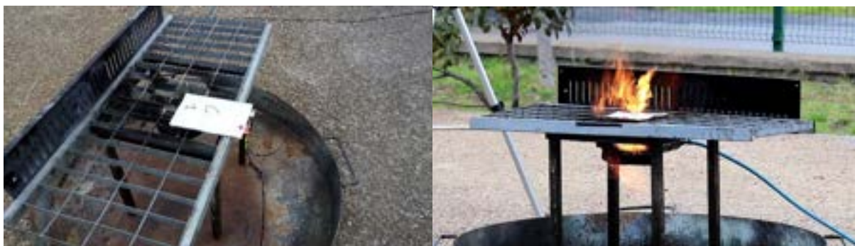
Figura 2 Posizionamento sul braciere e innesco incendio di una cella EiG-C020.
