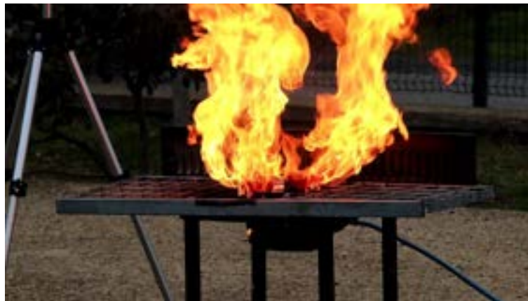
Figura 3 Prova di esposizione a fiamma di una cella EiG-C020 carica.
