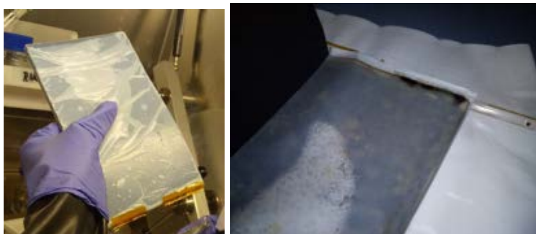
Figura 24 Separatore polimerico di una cella EiG-C020 vergine (sinistra) e rigonfia (destra).
