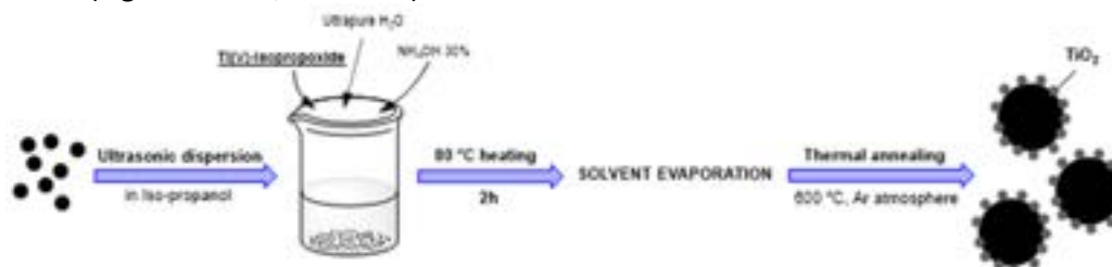
Figura 1. Sintesi dei composti Si@TiO 2 e Sn@TiO 2 .
