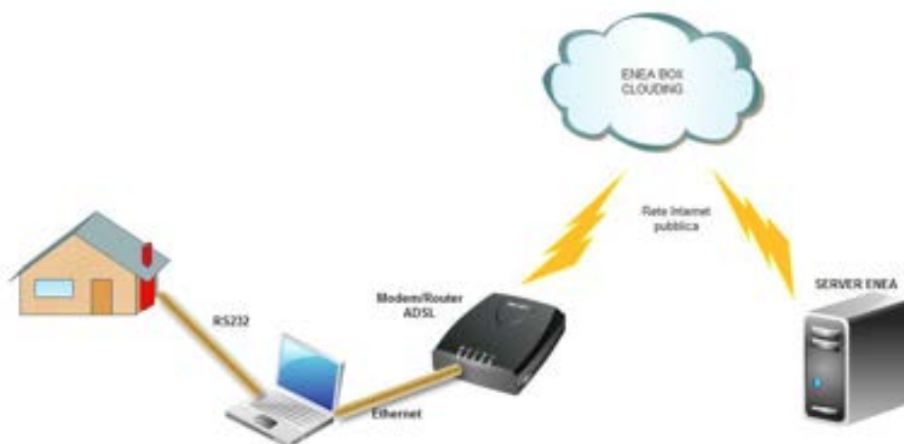
Figura 124. Sistema di misura con PC e software in loco, dati in Clouding
