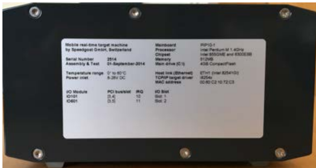
Figura 77: caratteristiche tecniche di Speedgoat real-time target machine
