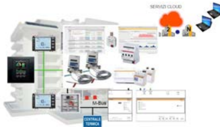
Figura 109. Integrazione sistema telelettura (M-Bus) con sistema di telegestione (KNX). Contabilizzazione diretta.
