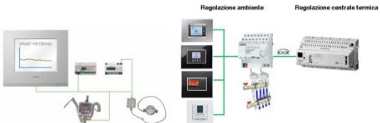
Figura 117. Applicazioni KNX. Sistema di lettura e sistema di regolazione.
