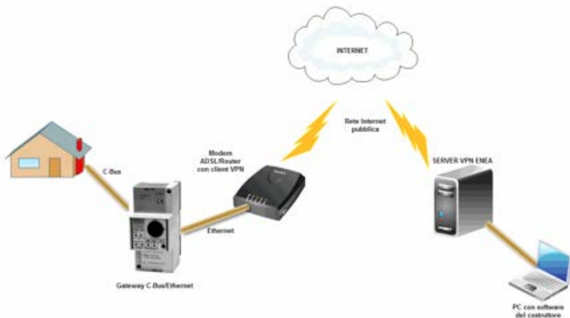
Figura 125. Sistema di misura con Gateway, connessione VPN e software operante su PC ENEA
