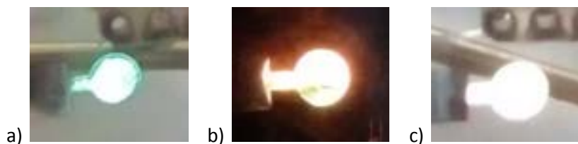
Figura 156. a) Dispositivo 12% IrFPHQ3; b) dispositivo 6% IrFPHQ3; c) dispositivo 2% IrFPHQ3.
