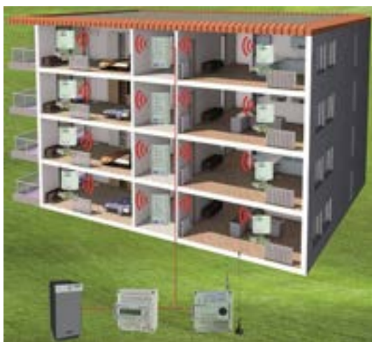
Figura 90. Architettura del sistema di regolazione wireless. Costruttore 3.
