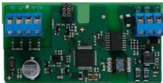
Figura 111. Modulo di comunicazione Modbus RS485 per heat meter M-Bus.
