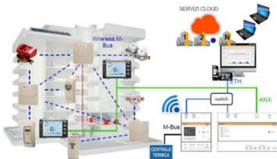
Figura 110. Integrazione sistema telelettura (M-Bus e WM-Bus) con sistema di telegestione (KNX). Contabilizzazione diretta e indiretta.
