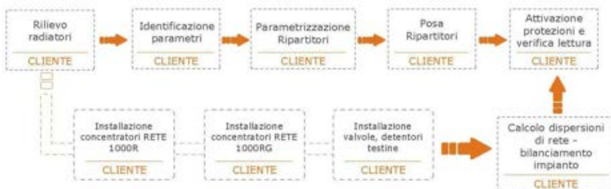
Figura 102. Servizio "Fai da te" – Installazione del sistema di regolazione e acquisizione dati. Costruttore 10.
