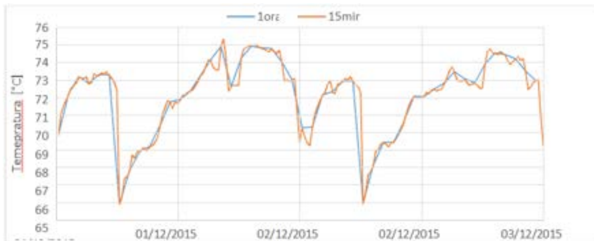
Figura 2. 12 - Profili di temperatura sul ritorno del CHP
