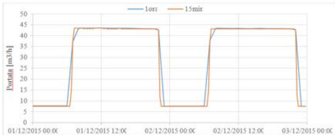
Figura 2. 14 – Profili di portata del CHP
