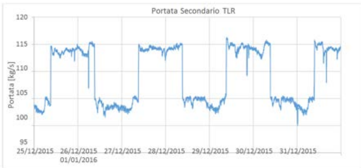
Figura 2. 20 - Portata lato secondario scambiatore TLR
