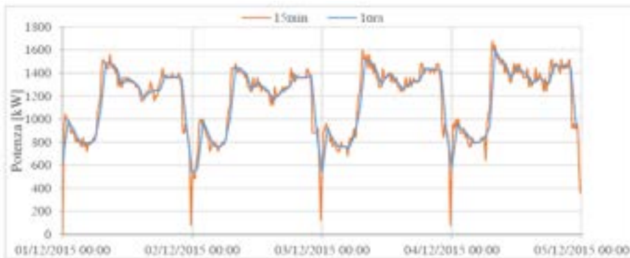
Figura 2. 26 - Profili di potenza ricavati scambiatore TLR
