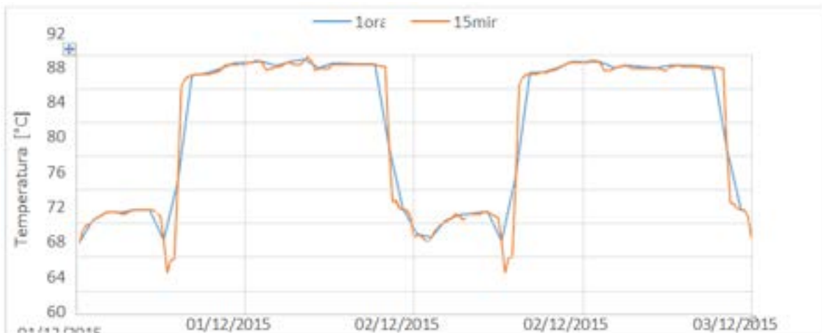
Figura 2. 11 - Profili di temperatura sulla mandata del CHP
