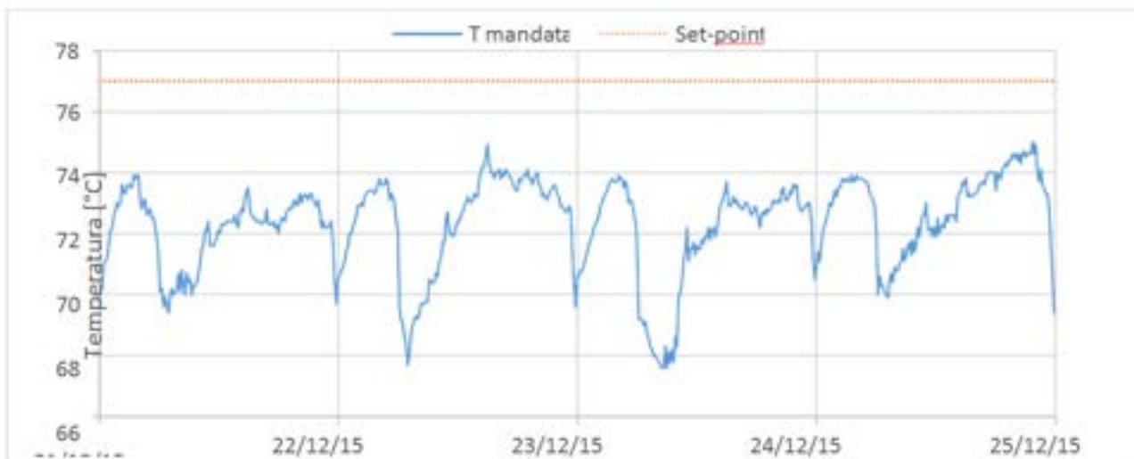
Figura 2. 21 - Temperatura di mandata lato secondario scambiatore TLR
