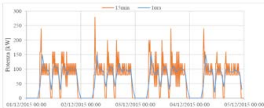
Figura 2. 28 - Profili di potenza ricavati edificio n°17 (allaccio indiretto)
