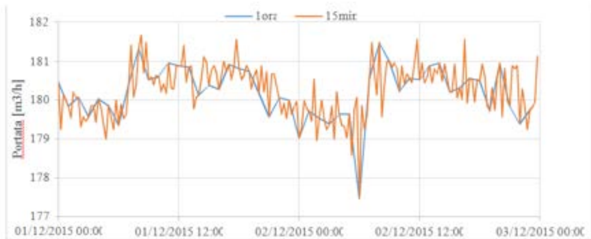
Figura 2. 13 – Profili di portata dello scambiatore TLR
