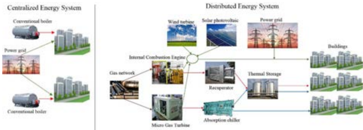
Figura 5. Rappresentazione di un tipico sistema di approvvigionamento convenzionale vs. una rete energetica distribuita a servizio di un distretto.
