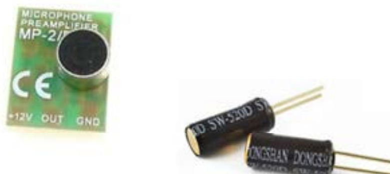
Figura 3.10 A sinistra un sensore acustico, a destra due sensori di vibrazione
