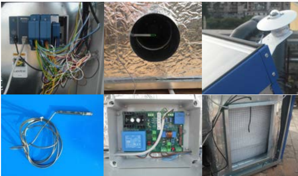
Figura 159. Foto di alcune parti dell'unità di acquisizione e controllo NI cDAQ 9184 e di alcune parti della strumentazione di misura attualmente utilizzata.
