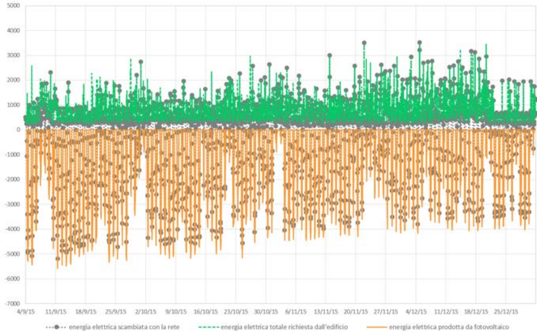
Figura 15. Energia elettrica totale richiesta per tutti gli usi, prodotta dal sistema fotovoltaico in copertura, e scambiata con la rete (si evidenzia la correzione del problema attraverso differenza degli altri valori di riferimento)
