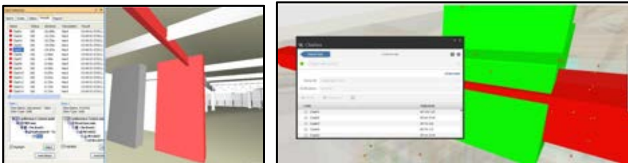
Fig. 33 CLASH DETECTION – interferenza Impianto – architettura
