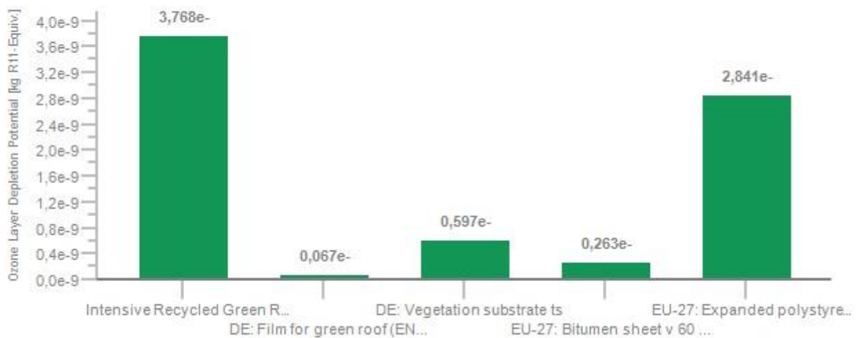
Figura 26 Riduzione dello Strato di Ozono, Indicatore di danno espresso per Kg R11 Eq. - Scenario 8cm
