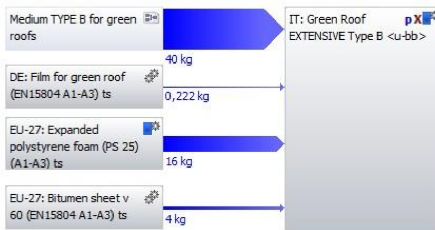
Figura 10 Schema del piano LCA per un Tetto Verde Estensivo con Medium di TIPO B - scenario di default 8cm
