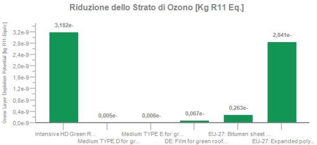
Figura 36 Riduzione dello Strato di Ozono, Indicatore di danno espresso per Kg R11 Eq. - Scenario 8cm
