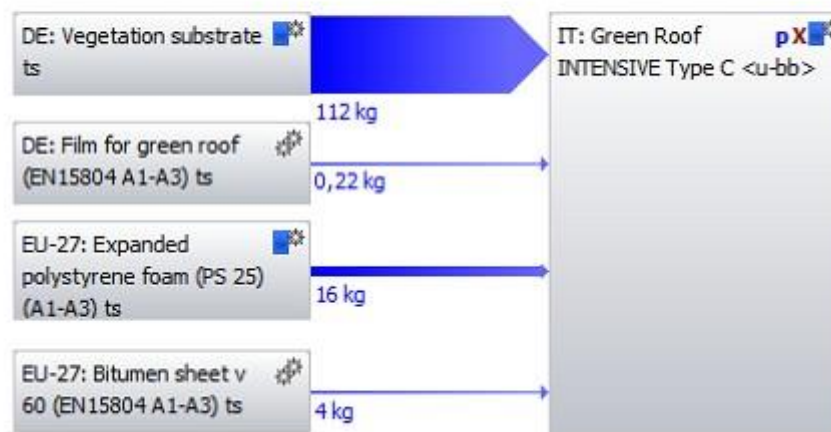
Figura 20 Schema del piano LCA per un Tetto Verde Intensivo con Medium di TIPO C - scenario di default 8cm
