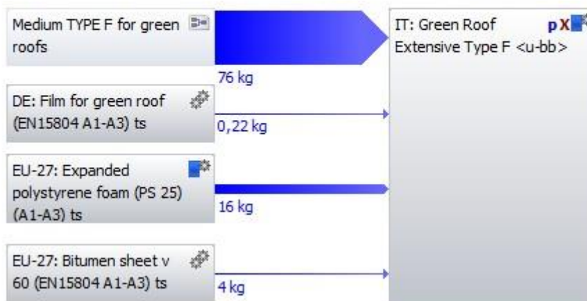
Figura 40 Schema del piano LCA per un Tetto Verde Estensivo con Medium di TIPO F - scenario di default 8cm
