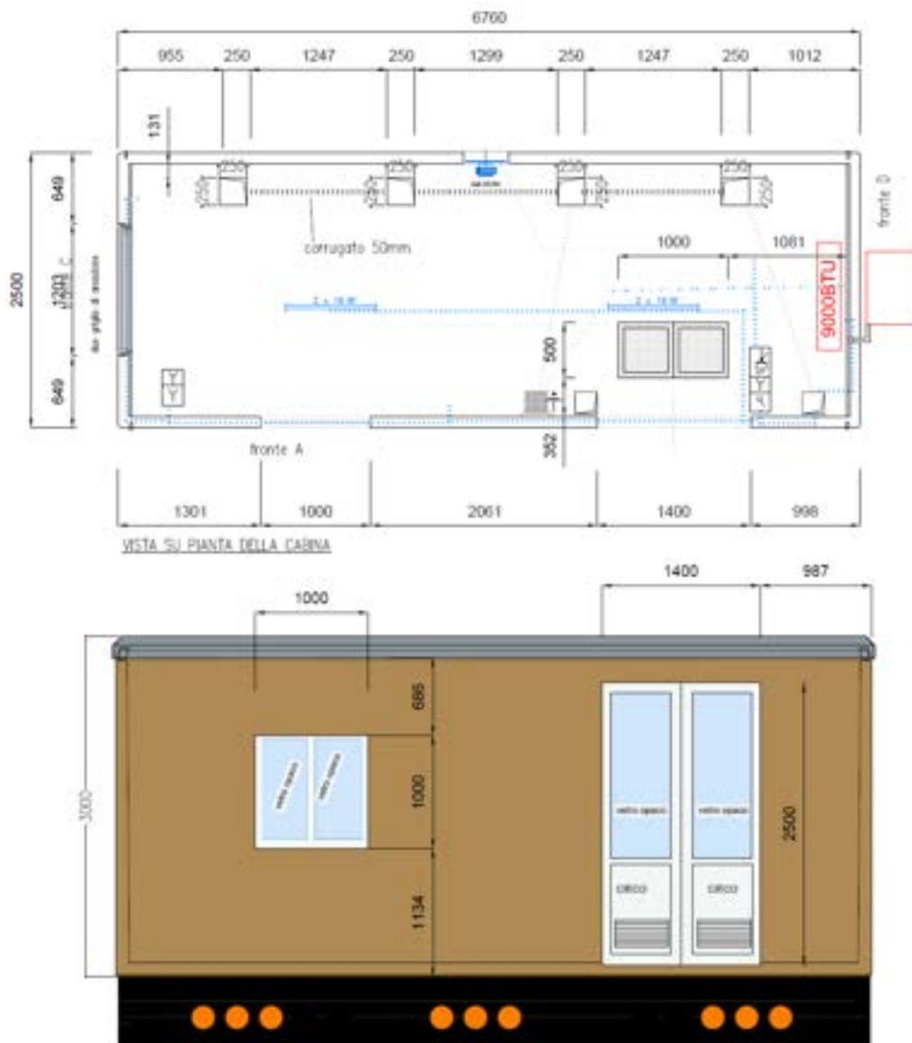
Figura 73: caratteristiche geometriche e costruttive delle cabine
