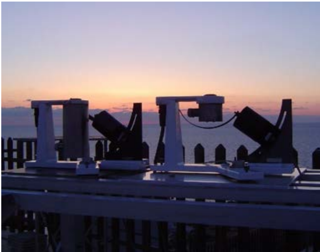
Figura 171.: Radiometri a banda rotante MFRSR sul tetto dell'Osservatorio Atmosferico di Lampedusa.
