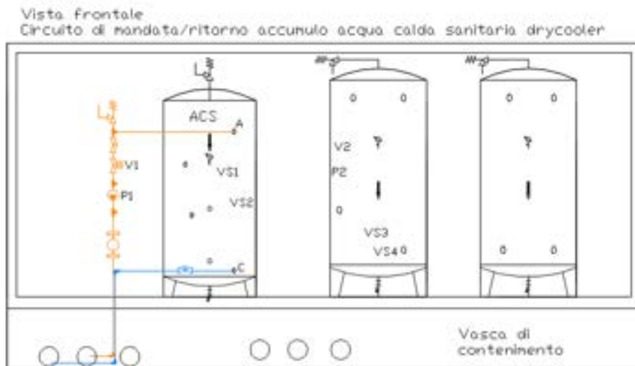
Figura 108: layout del circuito secondario ACS (vista prospetto)
