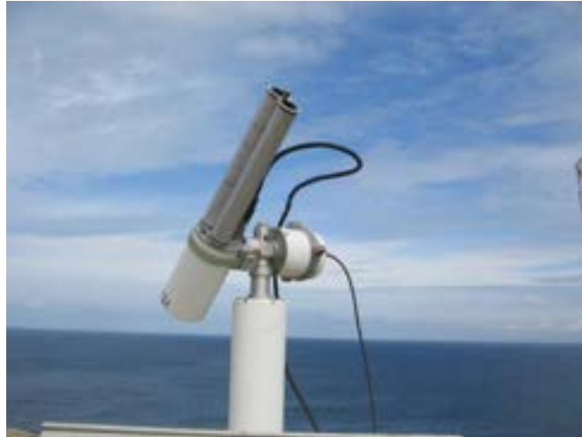
Figura 170: Fotometro solare Cimel CE 318 operante a Lampedusa.
