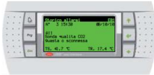
Figura 58 Display esterno per il controllo dei parametri in input e in output dell'emulatore
