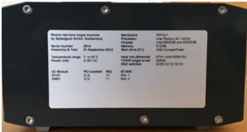
Figura 127: caratteristiche tecniche di Speedgoat real-time target machine
