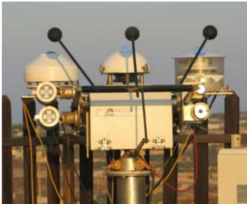
Figura 169. Inseguitore solare Kipp and Zonen 2AP con radiometri (un radiometro Kipp and Zonen CMP21 e Eppley PSP sono rispettivamente al centro ed a destra sul piano superiore dell'inseguitore), fotometri solari Middleton SP02 (alloggiati sul fianco sinistro), e pireliometro Kipp and Zonen CHP1 (fianco destro) operativo a Lampedusa.
