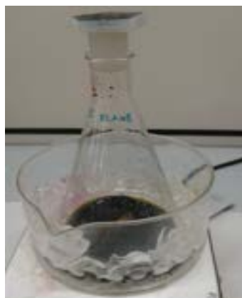
Figura 48. Miscela di grafite e acido solforico durante l'aggiunta di permanganato di potassio.
