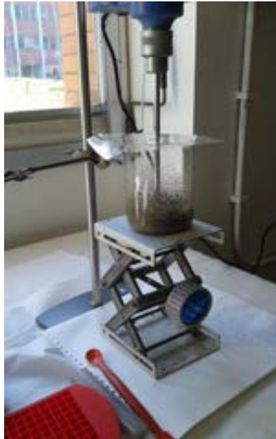
Figura 60. Set-up utilizzato per l'impasti di cemento e cemento+GO per la formatura di provini.
