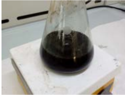
Figura 42. Campione dopo 20 ore di ossidazione e l'aggiunta di H 2 O distillata.
