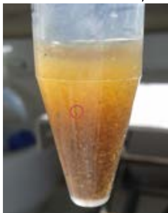
Figura 45. Frazione di precipitato ottenuto dopo diluizione in acqua distillate e sonicazione per 2 minuti dove il cerchio di colore rosso evidenzia le particelle di grafite non reagita.
