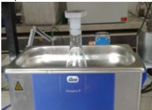
Figura 47. Sonicazione della miscela Grafite+ acido solforico in un bagno ad ultrasuoni
