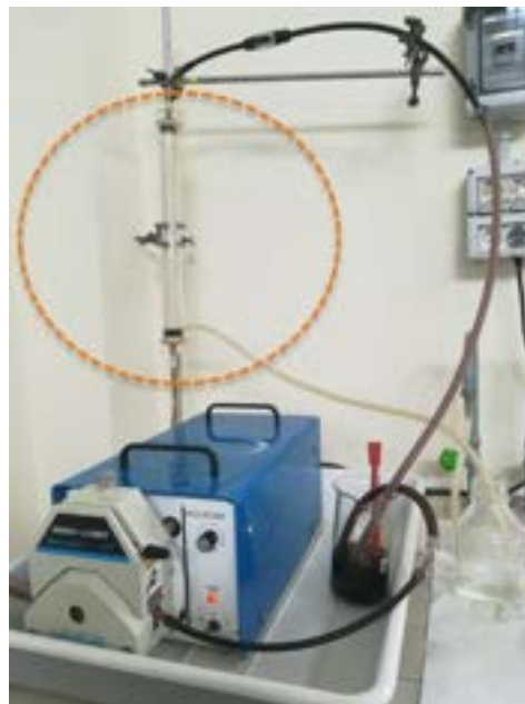
Figura 52. Set-up di filtrazione tangenziale
