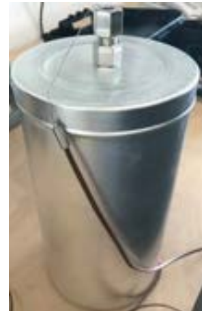
Figura 29. Posizionamento delle termocoppie per effettuare le misure di temperatura nel caso di sistema di accumulo con PCM e schiuma metallica.
