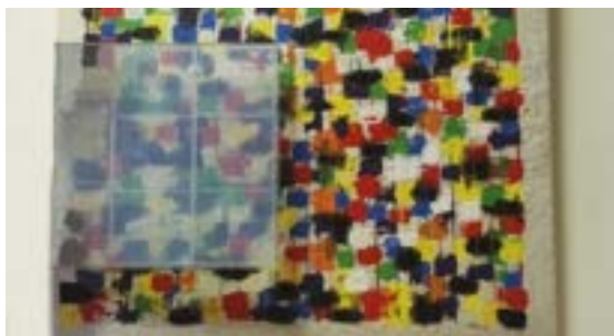
Figura 51 - Campione di vetrocamera con aerogel monolitico in intercapedine
