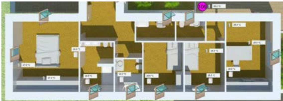
Figura 7. Interfaccia Design - Particolare della rappresentazione degli ambienti dell'edificio con valori misurati dai principali sensori e stato di apertura delle finestre, nella piattaforma di supervisione del sistema.
