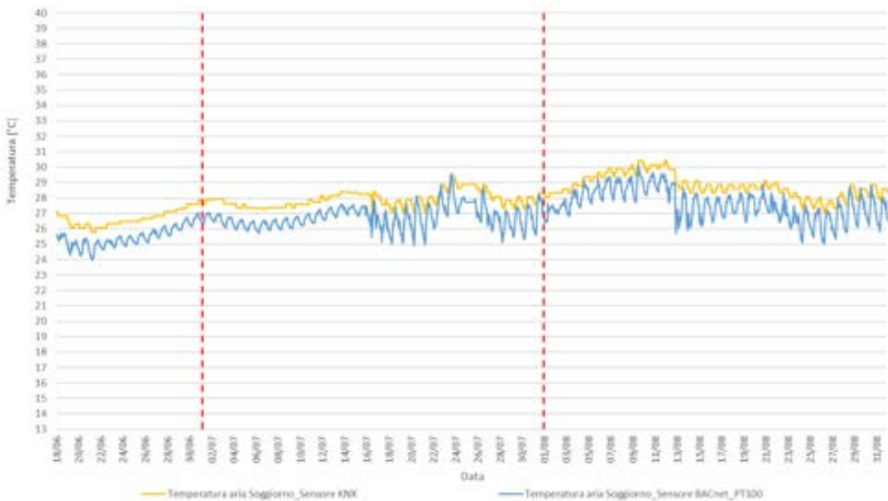
Figura 60. Temperature dell'aria del soggiorno misurate attraverso il sensore collegato al sistema Konnex e il sensore (PT100) collegato al sistema BACnet.
