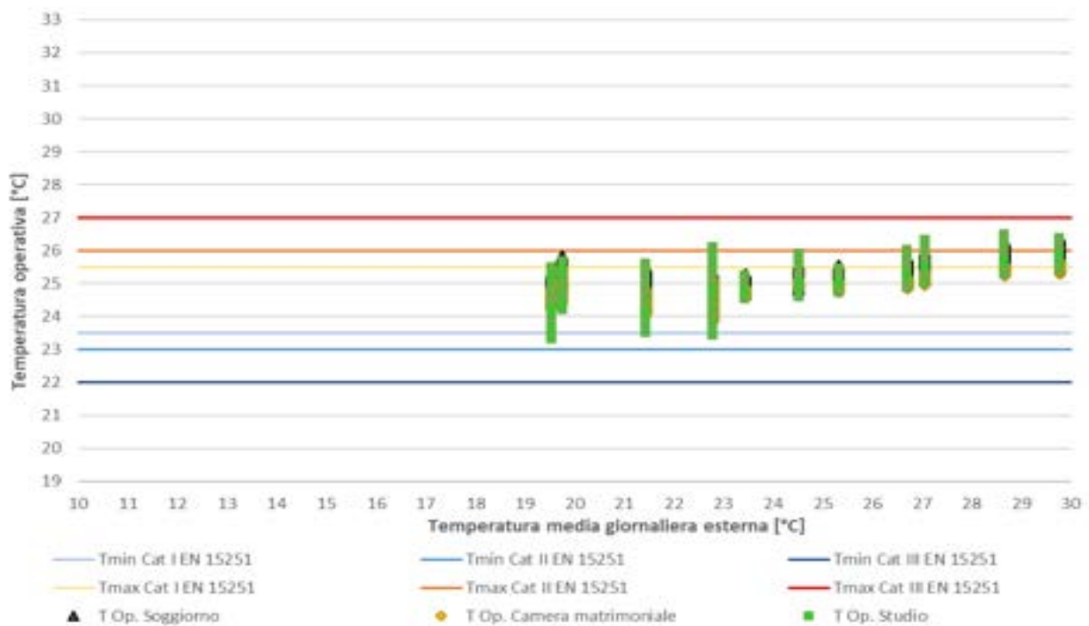
Figura 67. Modello adattivo, temperatura operativa di soggiorno, camera matrimoniale, studio, in funzione della temperatura media giornaliera esterna, giugno 2017.
