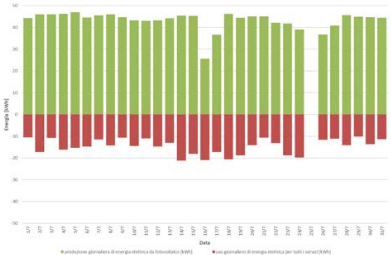
Figura 37. Produzione e uso di energia elettrica giornaliera per tutti i servizi dell'edificio - luglio 2017.
