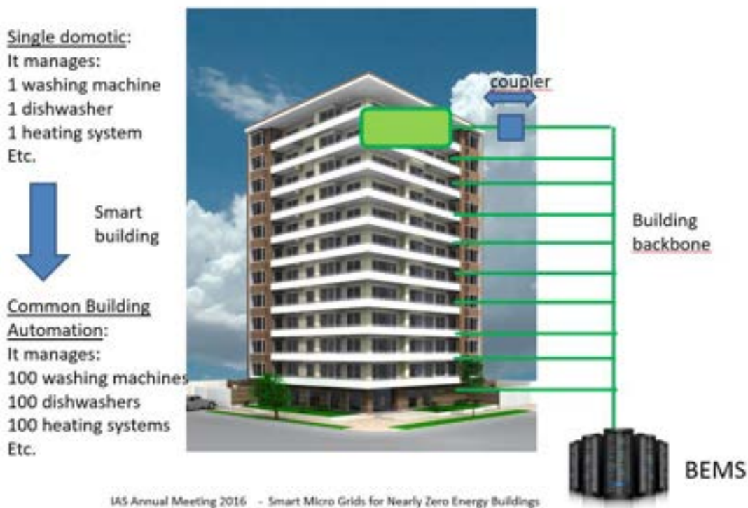
Figura 29. Schema del sistema BEMS di edificio.
