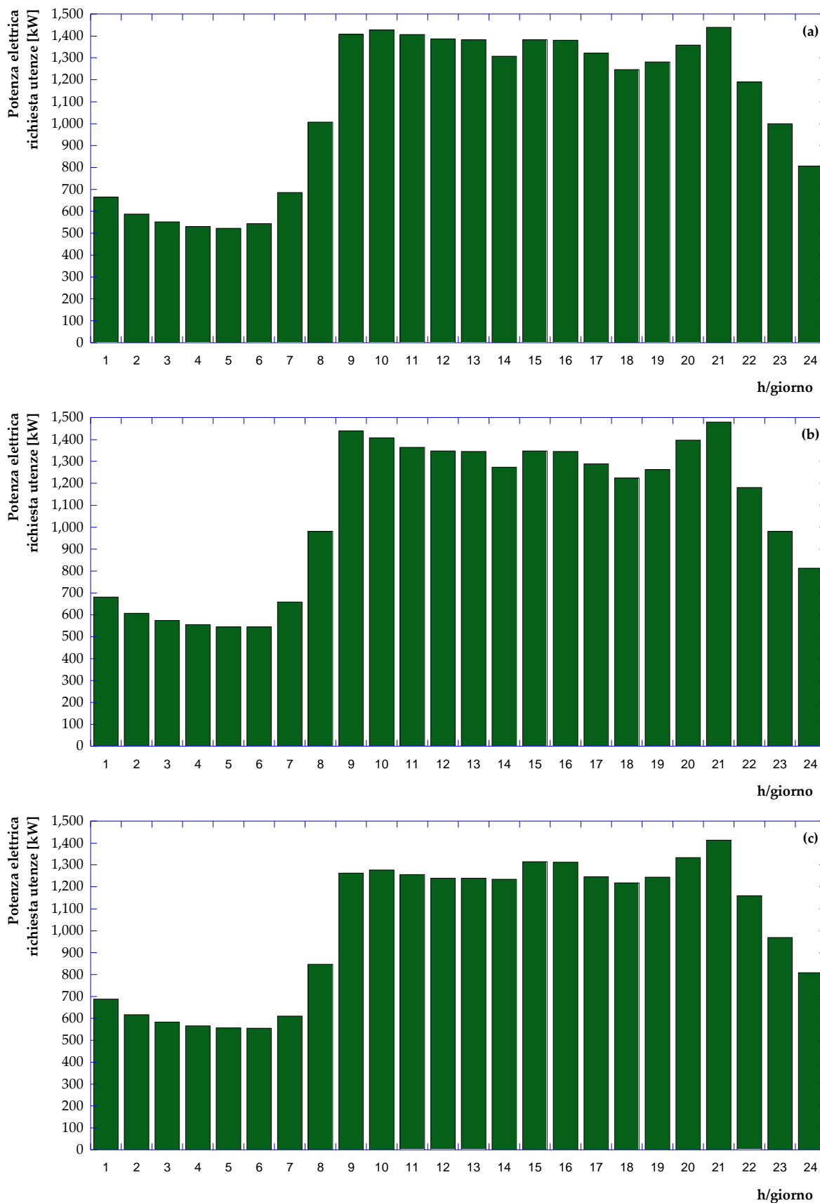
Figura 21 – Andamento della potenza elettrica richiesta dalle utenze nel giorno tipo (a) invernale, (b) di mezza stagione e (c) estivo
