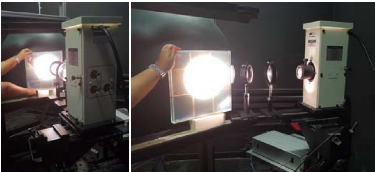
Figura 6. Caratterizzazione ottica: spettrofotometro non convenzionale, CA.TRA.M. (ENEA).
