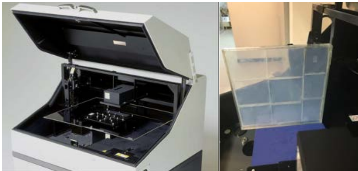
Figura 5. Caratterizzazione ottica: spettrofotometro Shimadzu SolidSpec-3700 (UNIPG).
