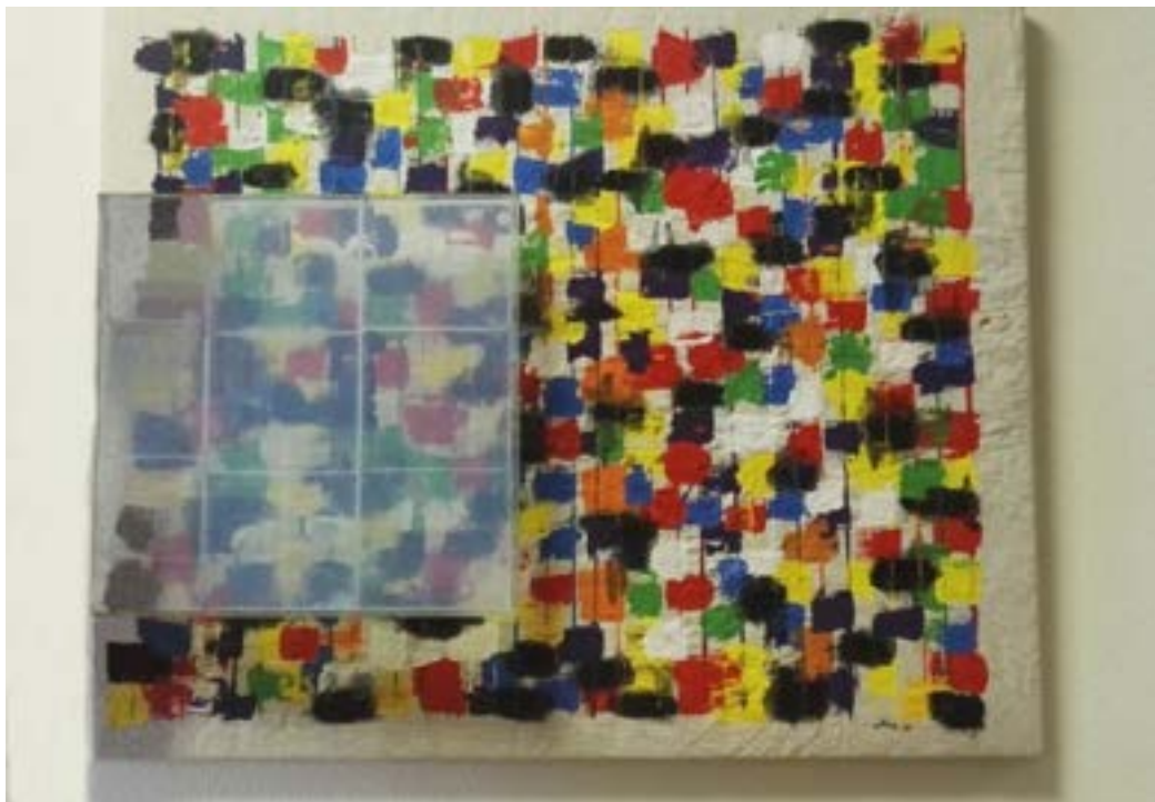
Figura 4. Campione di vetrocamera con aerogel monolitico in intercapedine.
