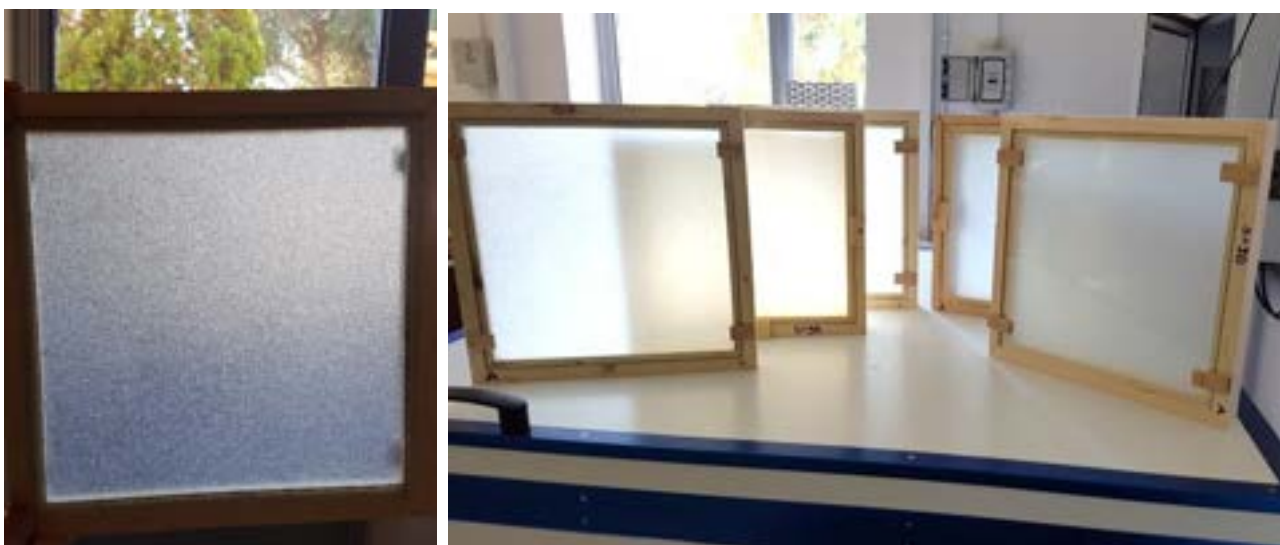
Figura 18. Vetrocameri con aerogel granulare in intercapedine.
