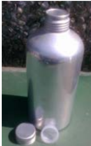
Figura 6. Bottiglia di alluminio per il contenimento del PCM.
