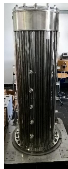
Figura 8. Foto del serbatoio con mantello in plexiglass.
