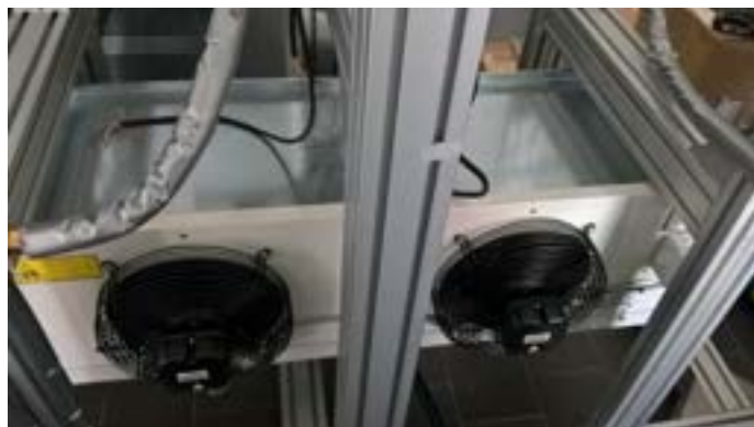
Figura 3. Scambiatore di calore utilizzato per simulare i carichi di refrigerazione
