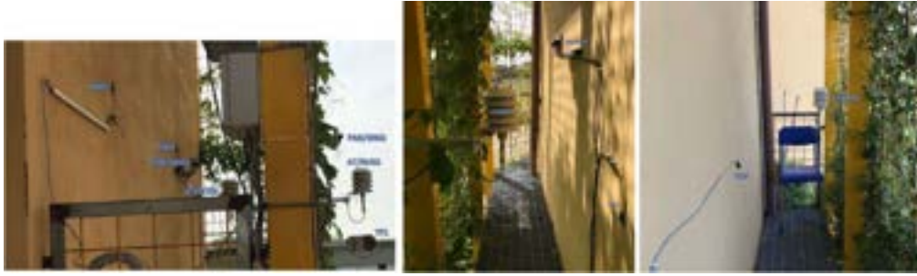
Figura 3. Disposizione sensori nel "gap"
