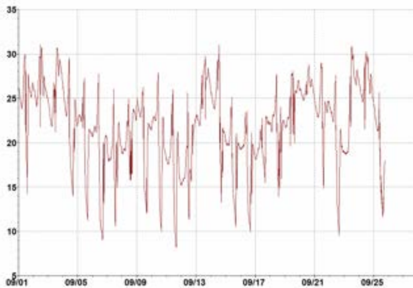
Figura 94 - Temperature acqua refrigerata all'uscita dalla macchina ad assorbimento, settembre 2018
