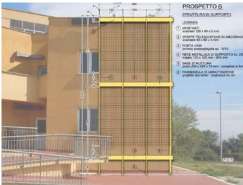
Figura 16- Prospetto della parete di sud-ovest
