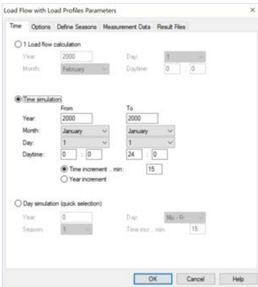
Figura 127 Parametri di calcolo del modulo Loadflow Time Simulation – Time.
