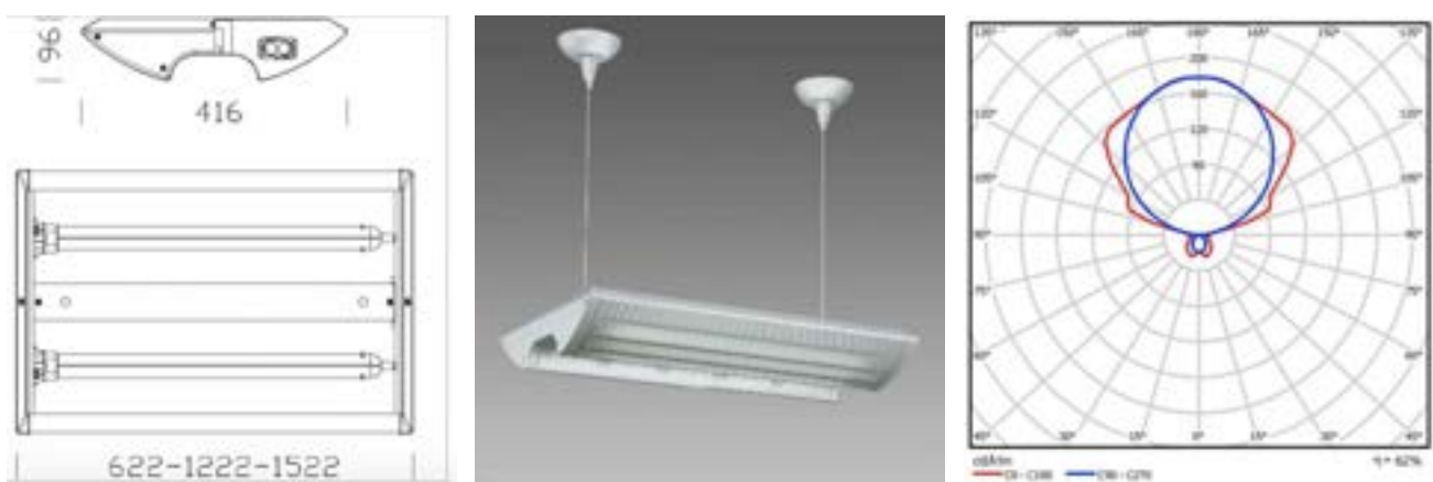
Figura 58 Disegni tecnici (a sinistra), fotografia (al centro) e solido fotometrico (a destra) delle plafoniere precedentemente installate.
