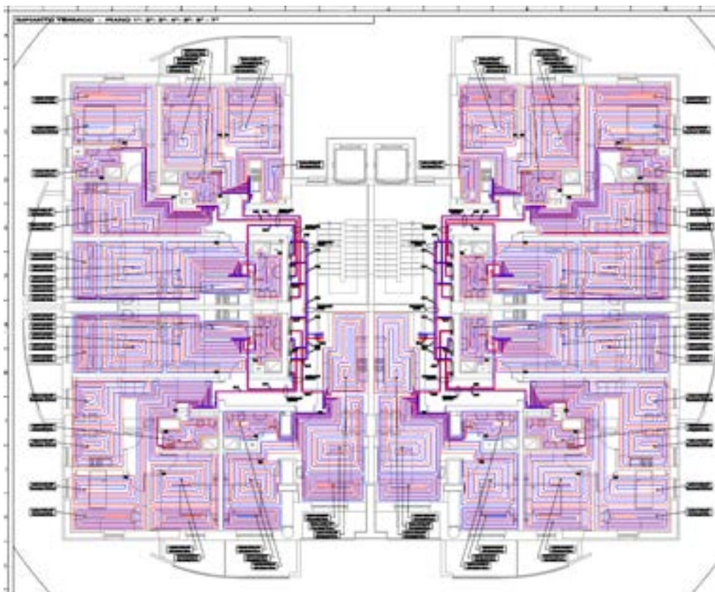
Figura 27. Schema dei pannelli radianti per la Torre A.
