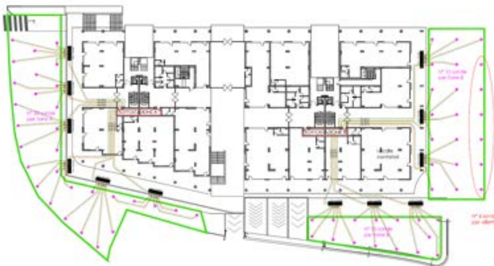
Figura 24. Schema delle sonde geotermiche
