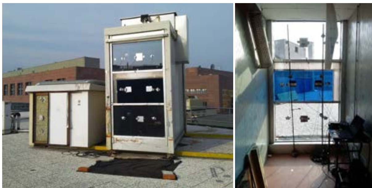
Figura 3. Vista esterna (destra) ed interna (sinistra) della facility sperimentale TWINS con il setup utilizzato per questo studio.
