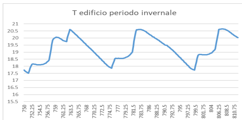
Figura 9: dettaglio temperatura media edificio simulato
