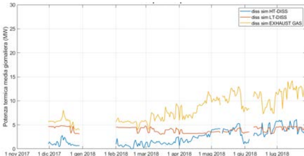
Figura 36 – Dispersioni termiche nei recuperatori di calore dei cogeneratori
