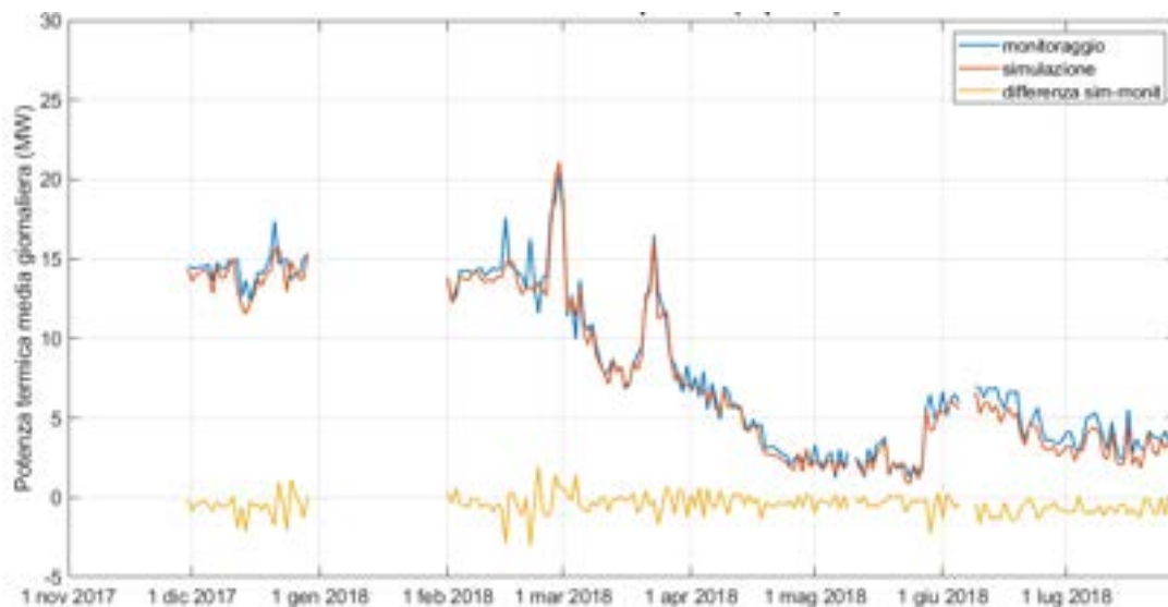
Figura 29 – Confronto simulazione vs. monitoraggio della potenza termica totale prodotta in CT
