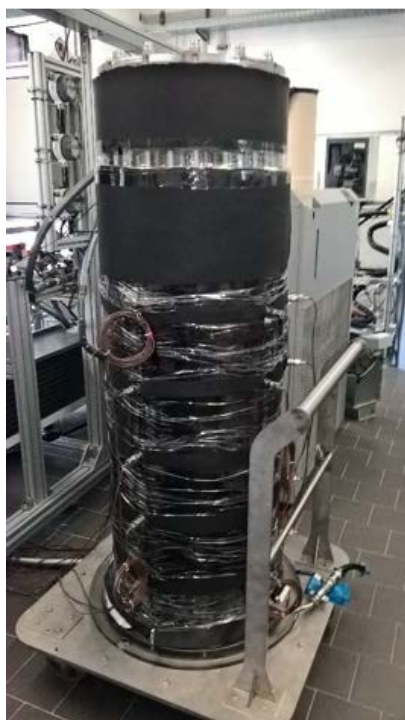
Figura 12. Serbatoio con mantello in plexiglass isolato termicamente.
