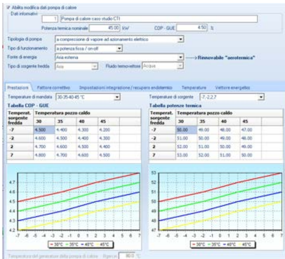
Figura 84: Caratteristiche della PdC della zona AULE
