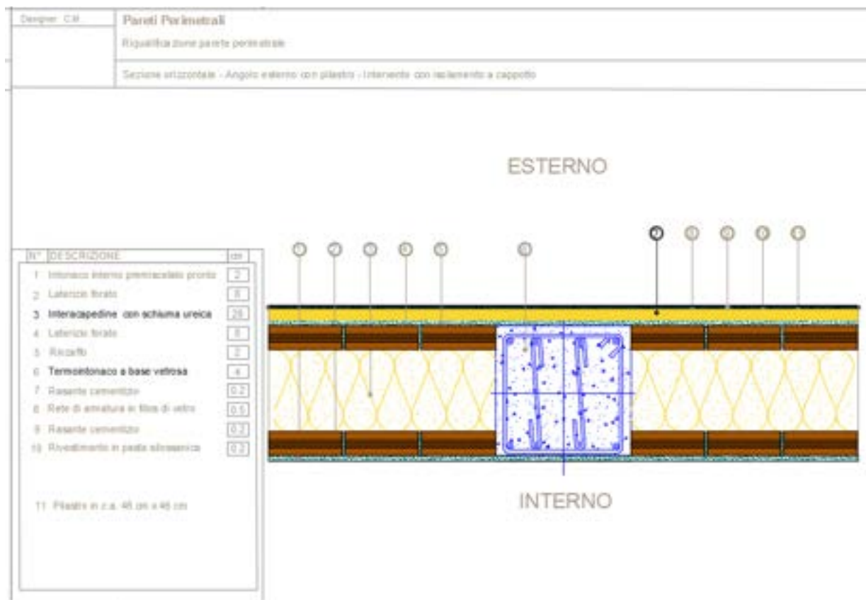
Figura 141: Pareti perimetrali coibentate
