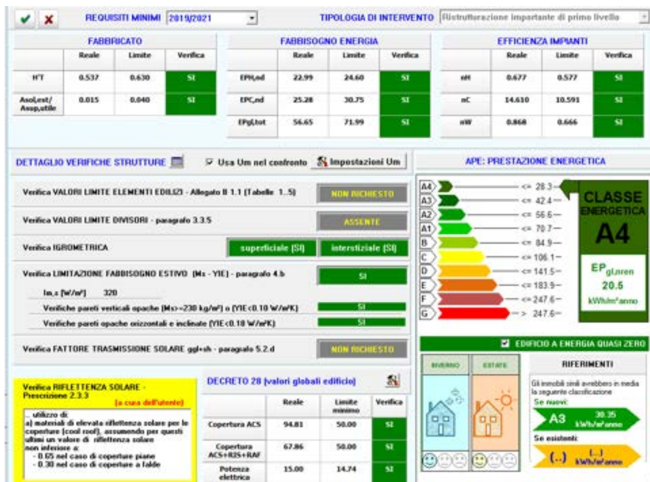
Figura 77: Sintesi delle verifiche globali dell'edificio riqualificato.
