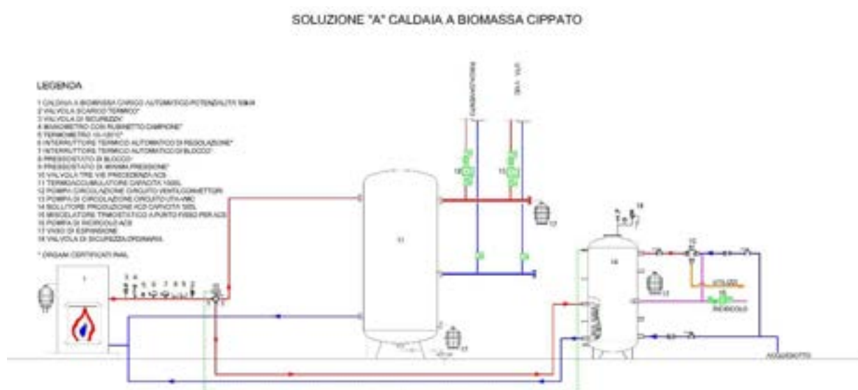
Figura 8 - Schema funzionale impianto di riscaldamento e produzione di ACS ipotizzato per lo scenario con caldaia a cippato.
