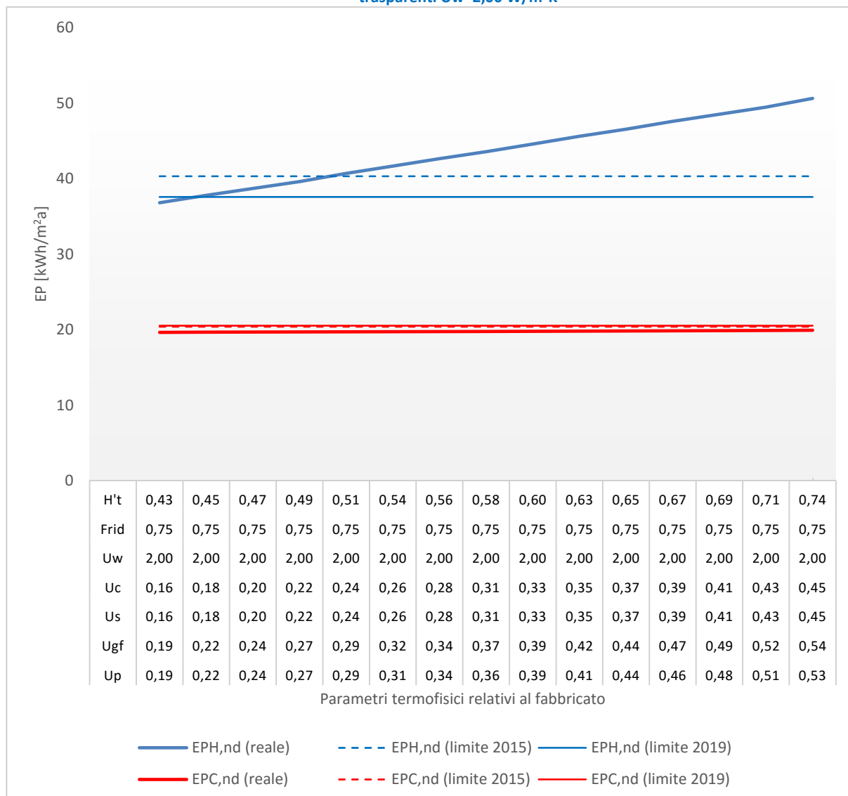
Figura 83 – Edificio ad uso scolastico - Località Roma (Zona climatica D). Variazione di tutti i parametri relativi al fabbricato ad eccezione del fattore di riduzione g_{gl+sh}/g_{gl} = 0,75 e della trasmittanza termica delle chiusure tecniche trasparenti U_w = 2,00 \text{ W/m}^2\text{K}
