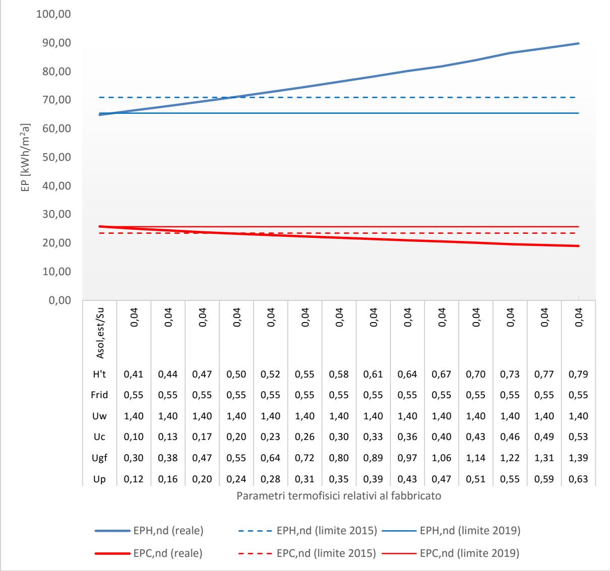
Figura 122 – Palazzina ad uso uffici - Località Torino (Zona climatica E). Variazione di tutti i parametri relativi al fabbricato ad eccezione della trasmittanza termica delle chiusure tecniche trasparenti U_w=1,40 \text{ W/m}^2\text{K} e del fattore di riduzione g_{gl+sh}/g_{gl} = 0,55
