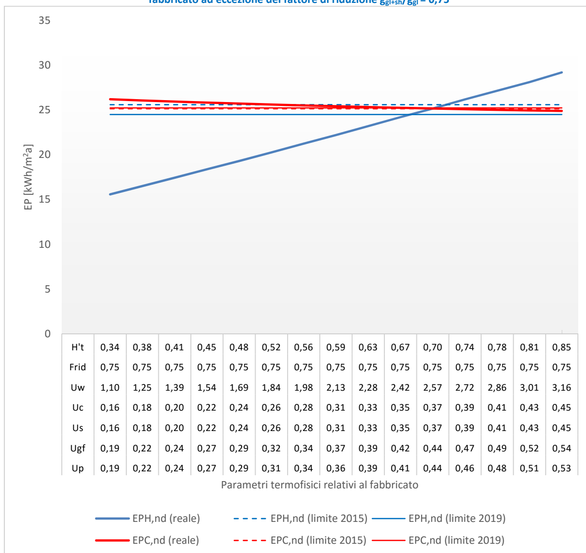
Figura 67 – Edificio ad uso scolastico - Località Palermo (Zona climatica B). Variazione di tutti i parametri relativi al fabbricato ad eccezione del fattore di riduzione g_{gl+sh}/g_{gl} = 0,75
