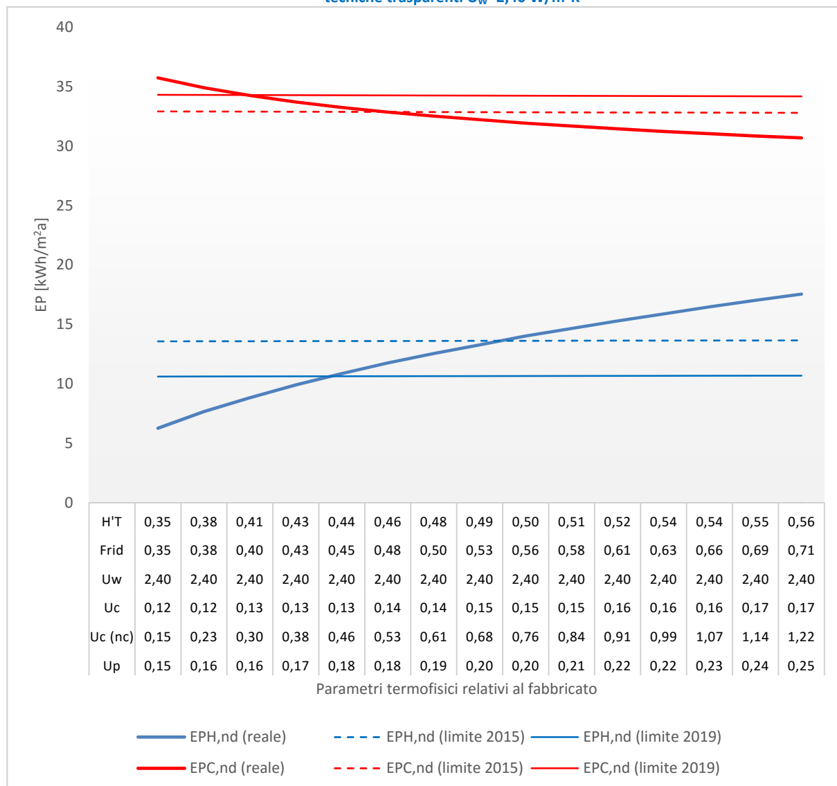
Figura 187 – Palazzina con destinazione d'uso residenziale - Località Roma (Zona climatica D). Unità Immobiliare U.I.8. Variazione di tutti i parametri relativi al fabbricato ad eccezione della trasmittanza termica delle chiusure tecniche trasparenti U_w=2,40 \text{ W/m}^2\text{K}
