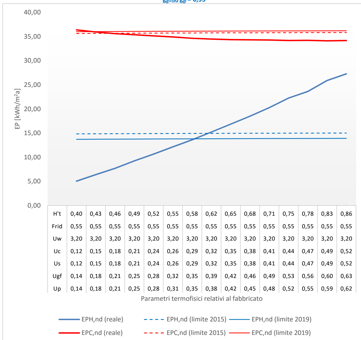
Figura 36 – Villa monofamiliare - Località Palermo (Zona climatica B). Variazione di tutti i parametri relativi al fabbricato ad eccezione della trasmittanza termica delle chiusure tecniche trasparenti U_w=3,20 \text{ W/m}^2\text{K} e del fattore di riduzione g_{gl+sh}/g_{gl} = 0,55
