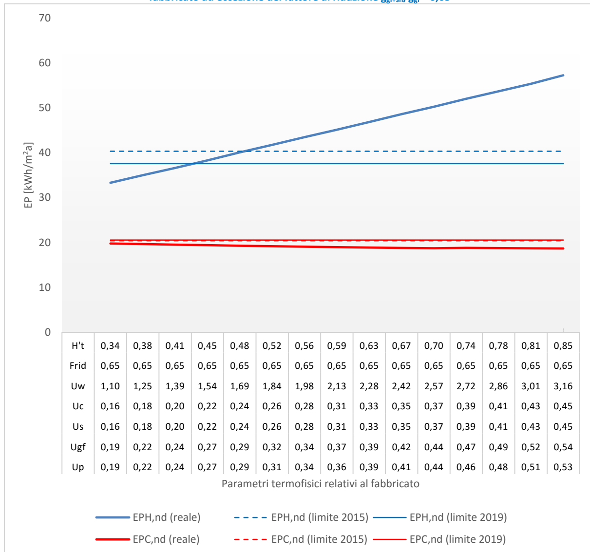
Figura 79 – Edificio ad uso scolastico - Località Roma (Zona climatica D). Variazione di tutti i parametri relativi al fabbricato ad eccezione del fattore di riduzione g_{gl+sh}/g_{gl} = 0,65
