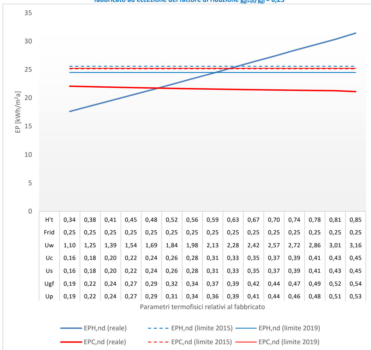
Figura 62 – Edificio ad uso scolastico - Località Palermo (Zona climatica B). Variazione di tutti i parametri relativi al fabbricato ad eccezione del fattore di riduzione g_{gl+sh}/g_{gl} = 0,25
