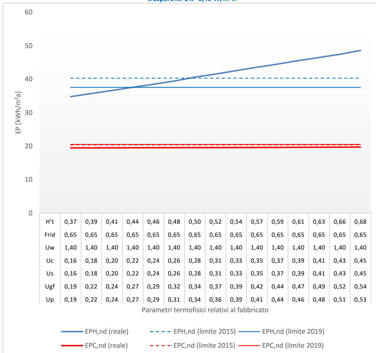
Figura 80 – Edificio ad uso scolastico - Località Roma (Zona climatica D). Variazione di tutti i parametri relativi al fabbricato ad eccezione del fattore di riduzione g_{gl+sh}/g_{gl} = 0,65 e della trasmittanza termica delle chiusure tecniche trasparenti U_w = 1,40 \text{ W/m}^2\text{K}
