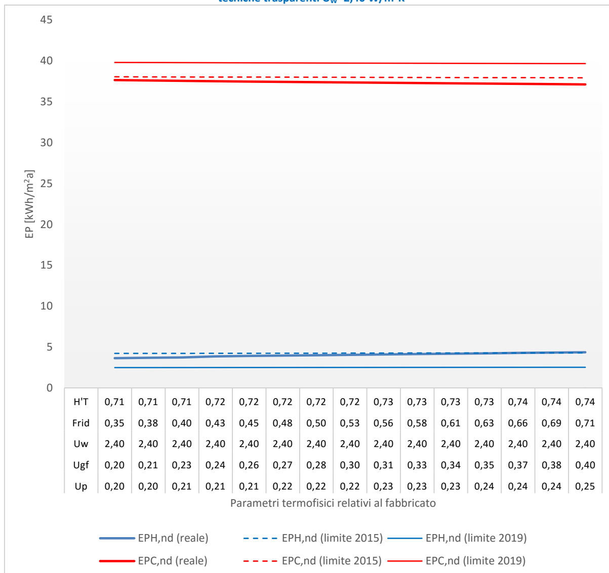
Figura 175 – Palazzina con destinazione d'uso residenziale - Località Roma (Zona climatica D). Unità Immobiliare U.I5. Variazione di tutti i parametri relativi al fabbricato dell'edificio ad eccezione della trasmittanza termica delle chiusure tecniche trasparenti U_w=2,40 \text{ W/m}^2\text{K}
