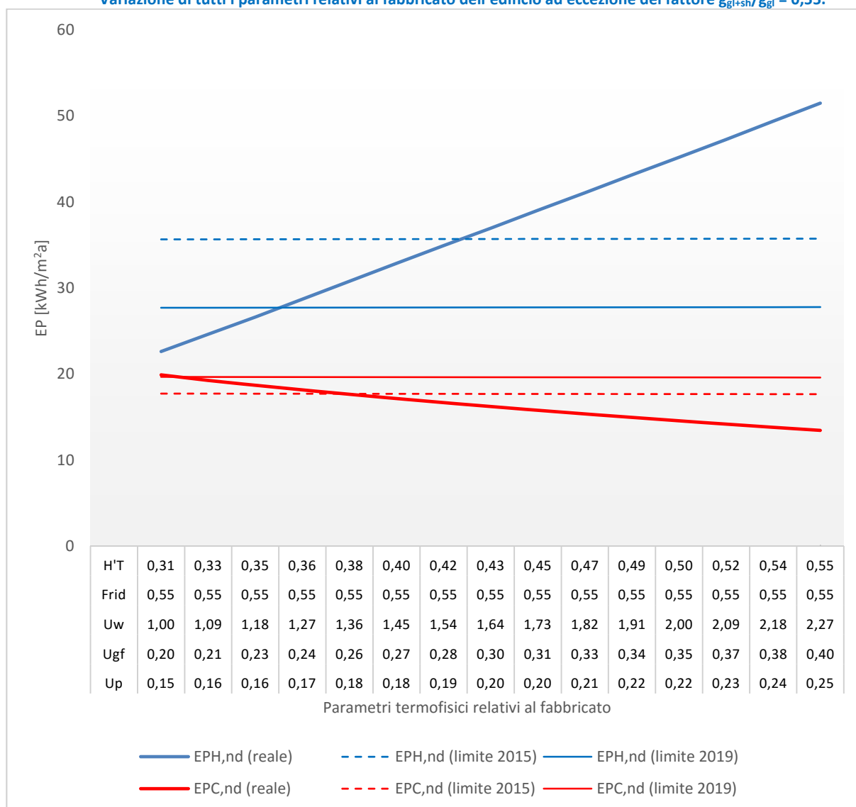
Figura 218 – Palazzina con destinazione d'uso residenziale - Località Torino (Zona climatica E). Unità Immobiliare U.I.3. Variazione di tutti i parametri relativi al fabbricato dell'edificio ad eccezione del fattore g_{gl+sh}/g_{gl} = 0,55 .
