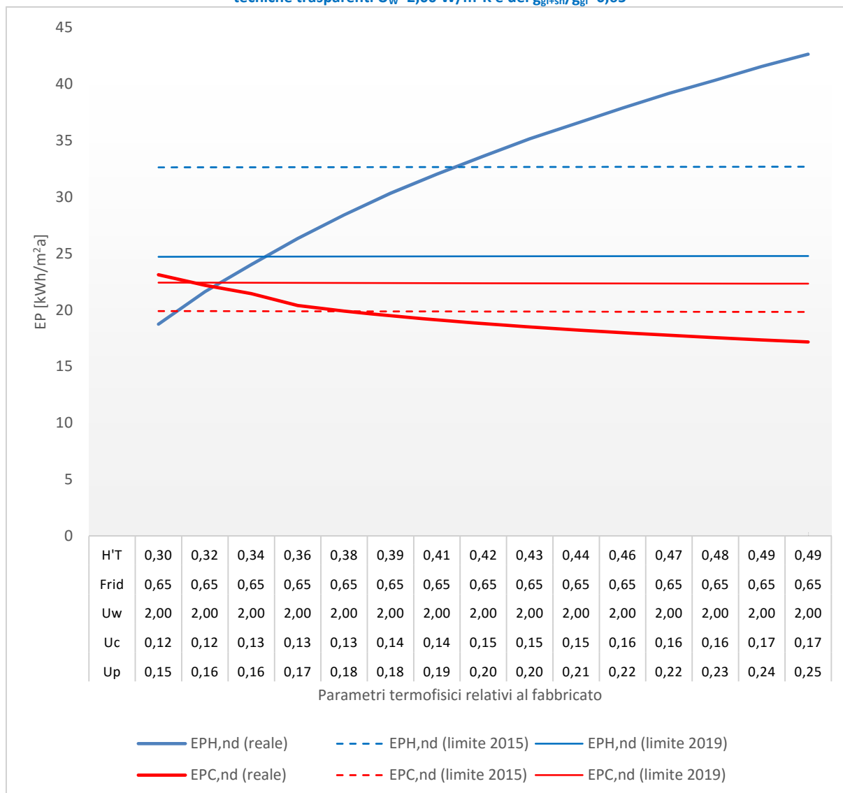
Figura 231 – Palazzina con destinazione d'uso residenziale - Località Torino (Zona climatica E). Unità Immobiliare U.I.7. Variazione di tutti i parametri relativi al fabbricato dell'edificio ad eccezione della trasmittanza termica delle chiusure tecniche trasparenti U_w=2,00 \text{ W/m}^2\text{K} e del g_{gl+sh}/g_{gl}=0,65
