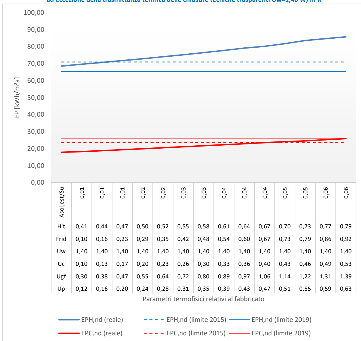
Figura 119 – Palazzina ad uso uffici - Località Torino (Zona climatica E). Variazione di tutti i parametri relativi al fabbricato ad eccezione della trasmittanza termica delle chiusure tecniche trasparenti U_w=1,40 \text{ W/m}^2\text{K}
