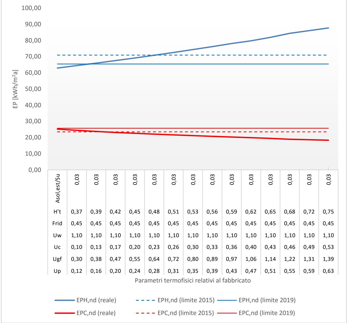
Figura 120 – Palazzina ad uso uffici - Località Torino (Zona climatica E). Variazione di tutti i parametri relativi al fabbricato ad eccezione della trasmittanza termica delle chiusure tecniche trasparenti U_w=1,10 \text{ W/m}^2\text{K} e del fattore di riduzione g_{gl+sh}/g_{gl} = 0,45
