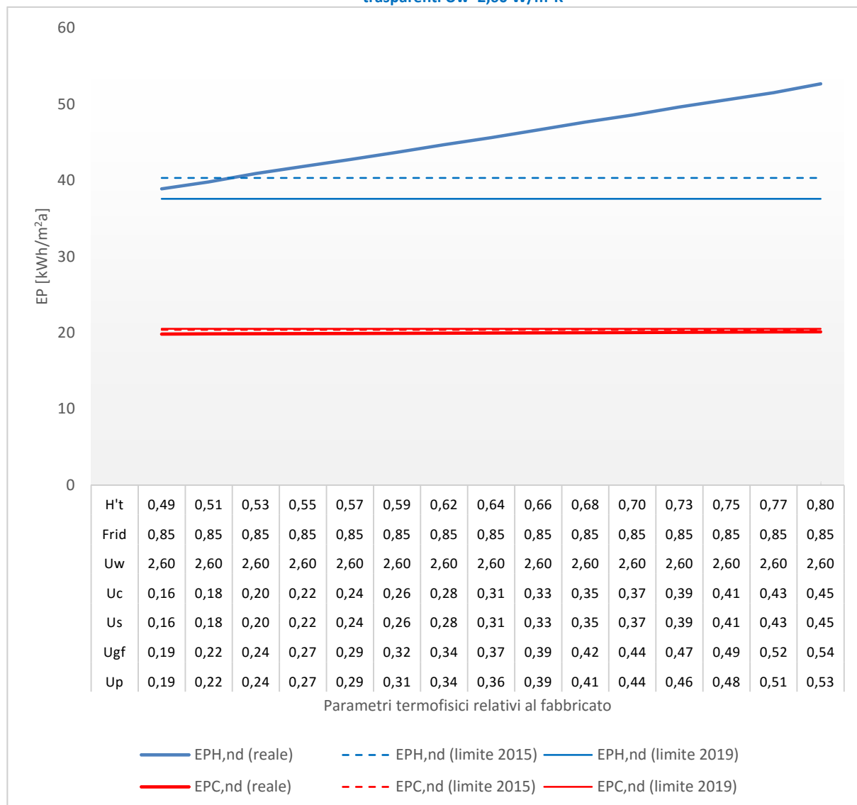
Figura 86 – Edificio ad uso scolastico - Località Roma (Zona climatica D). Variazione di tutti i parametri relativi al fabbricato ad eccezione del fattore di riduzione g_{gl+sh}/g_{gl} = 0,80 e della trasmittanza termica delle chiusure tecniche trasparenti U_w = 2,60 \text{ W/m}^2\text{K}
