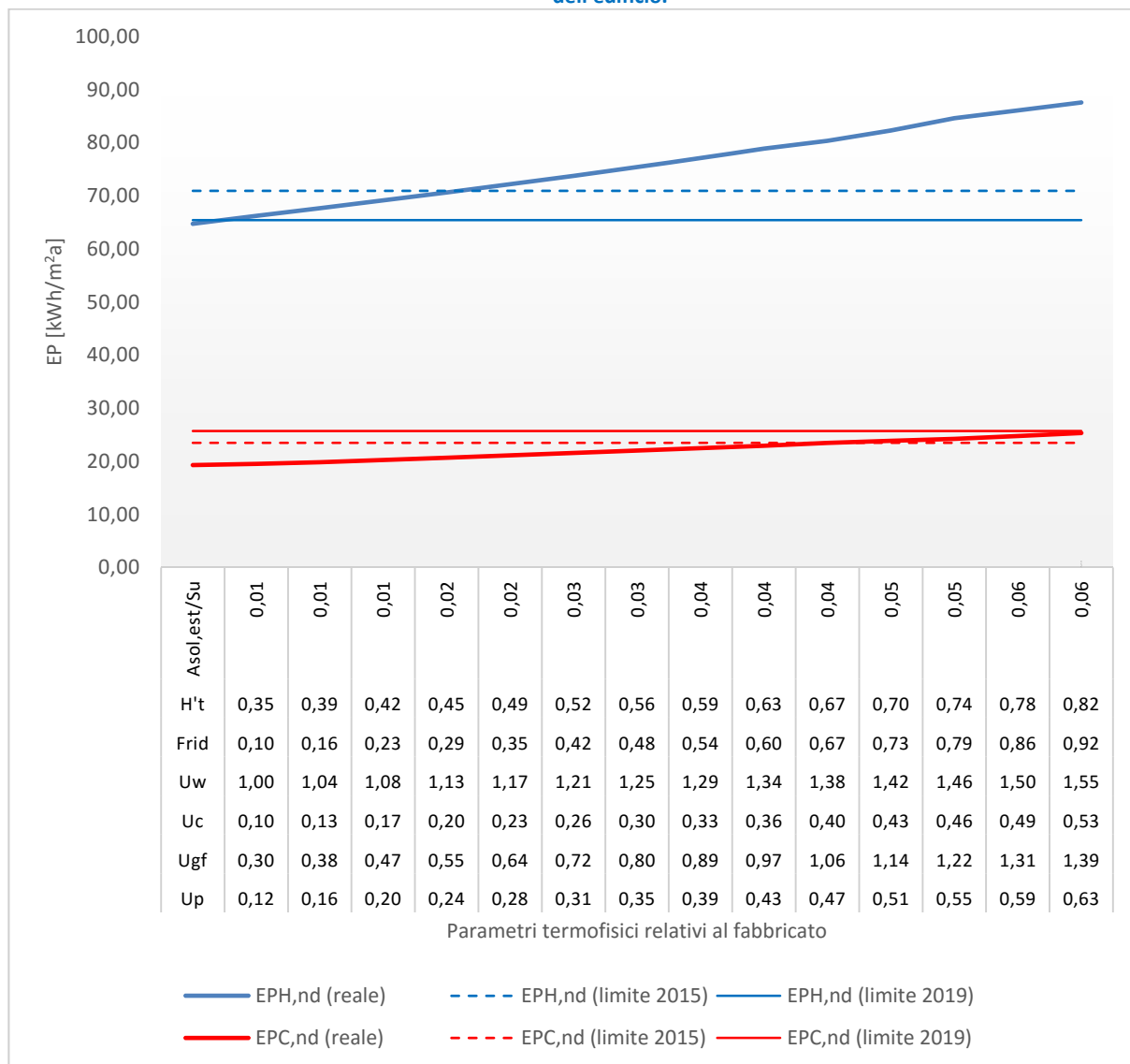
Figura 117 – Palazzina ad uso uffici - Località Torino (Zona climatica E). Variazione di tutti i parametri relativi al fabbricato dell'edificio.
