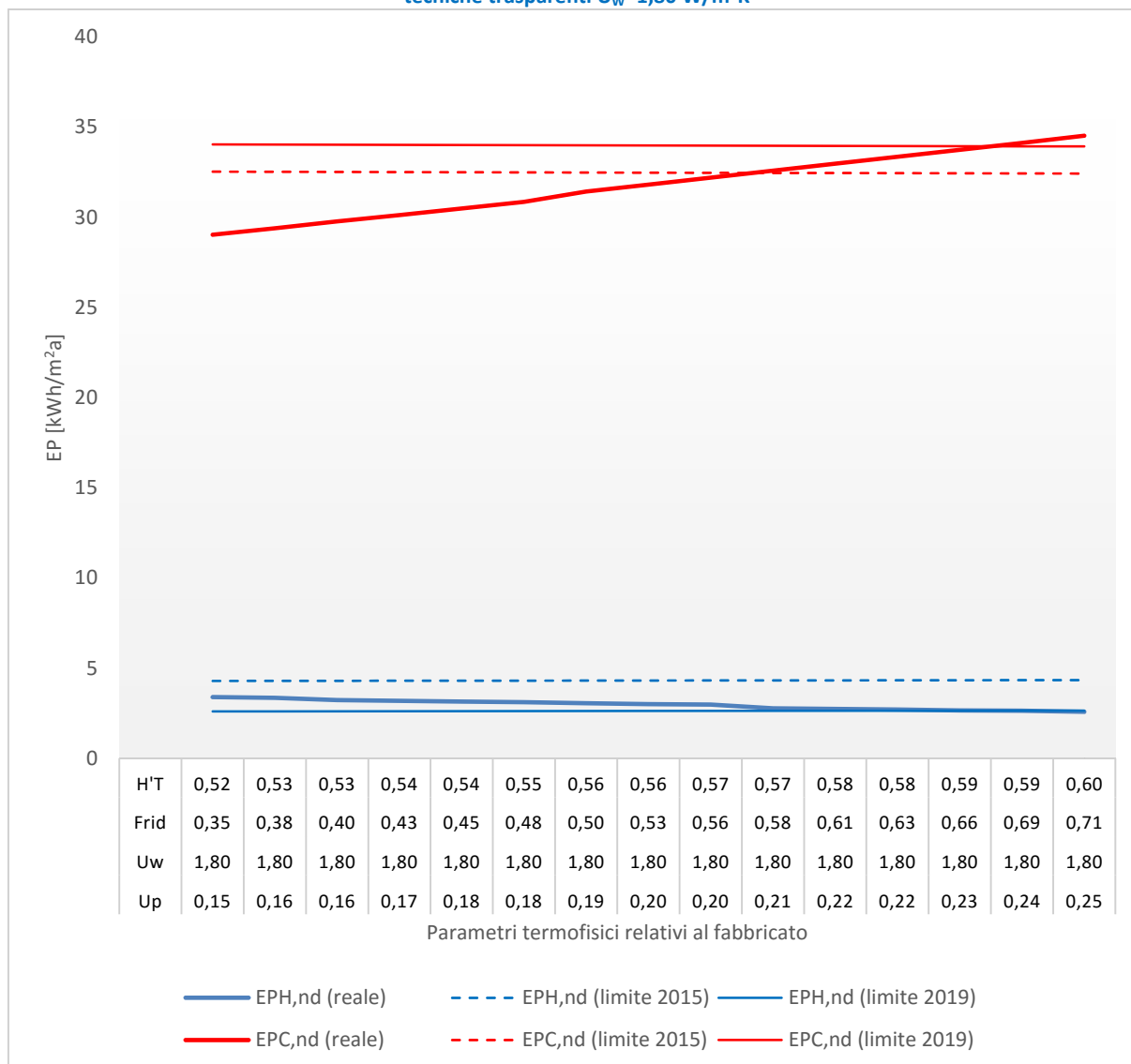
Figura 185 – Palazzina con destinazione d'uso residenziale - Località Roma (Zona climatica D). Unità Immobiliare U.I.6. Variazione di tutti i parametri relativi al fabbricato dell'edificio ad eccezione della trasmittanza termica delle chiusure tecniche trasparenti U_w=1,80 \text{ W/m}^2\text{K}
