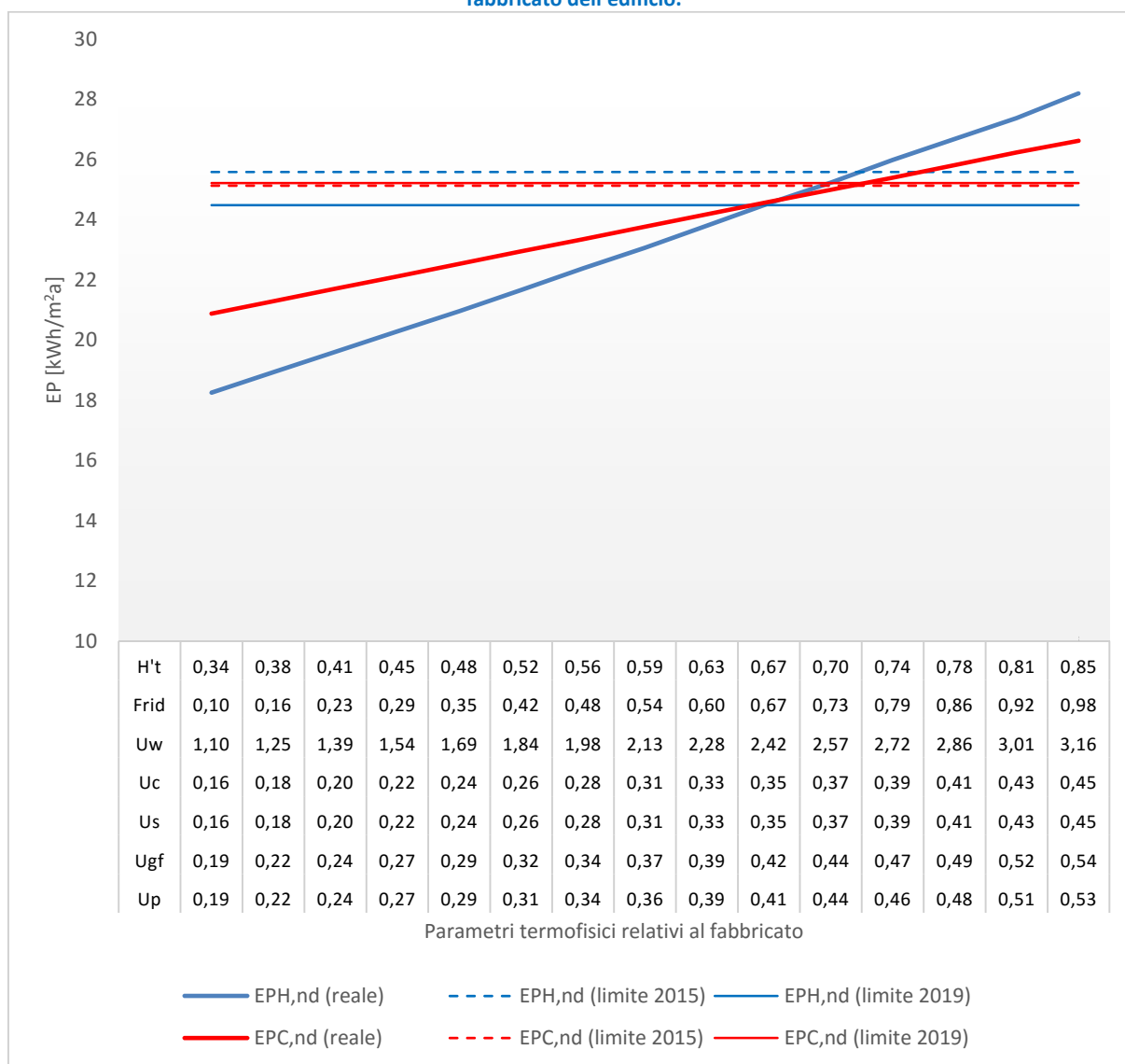
Figura 60 – Edificio ad uso scolastico - Località Palermo (Zona climatica B). Variazione di tutti i parametri relativi al fabbricato dell'edificio.
