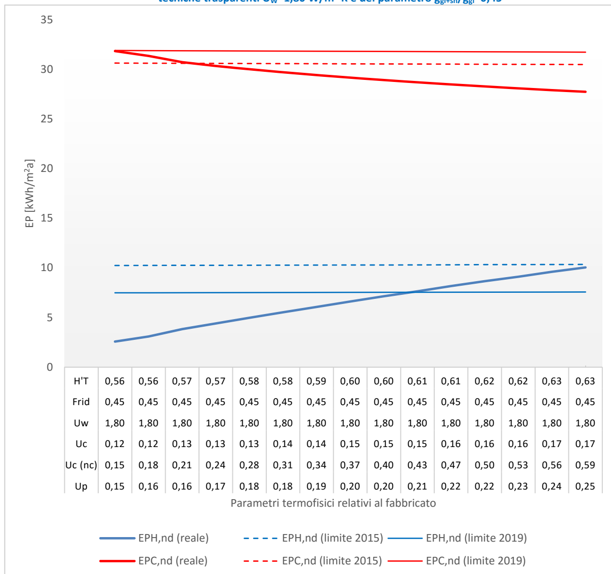
Figura 204 – Palazzina con destinazione d'uso residenziale - Località Roma (Zona climatica D). Unità Immobiliare U.I.7. Variazione di tutti i parametri relativi al fabbricato dell'edificio ad eccezione della trasmittanza termica delle chiusure tecniche trasparenti U_w=1,80 \text{ W/m}^2 \text{ K} e del parametro g_{gl+sh}/g_{gl}=0,45
