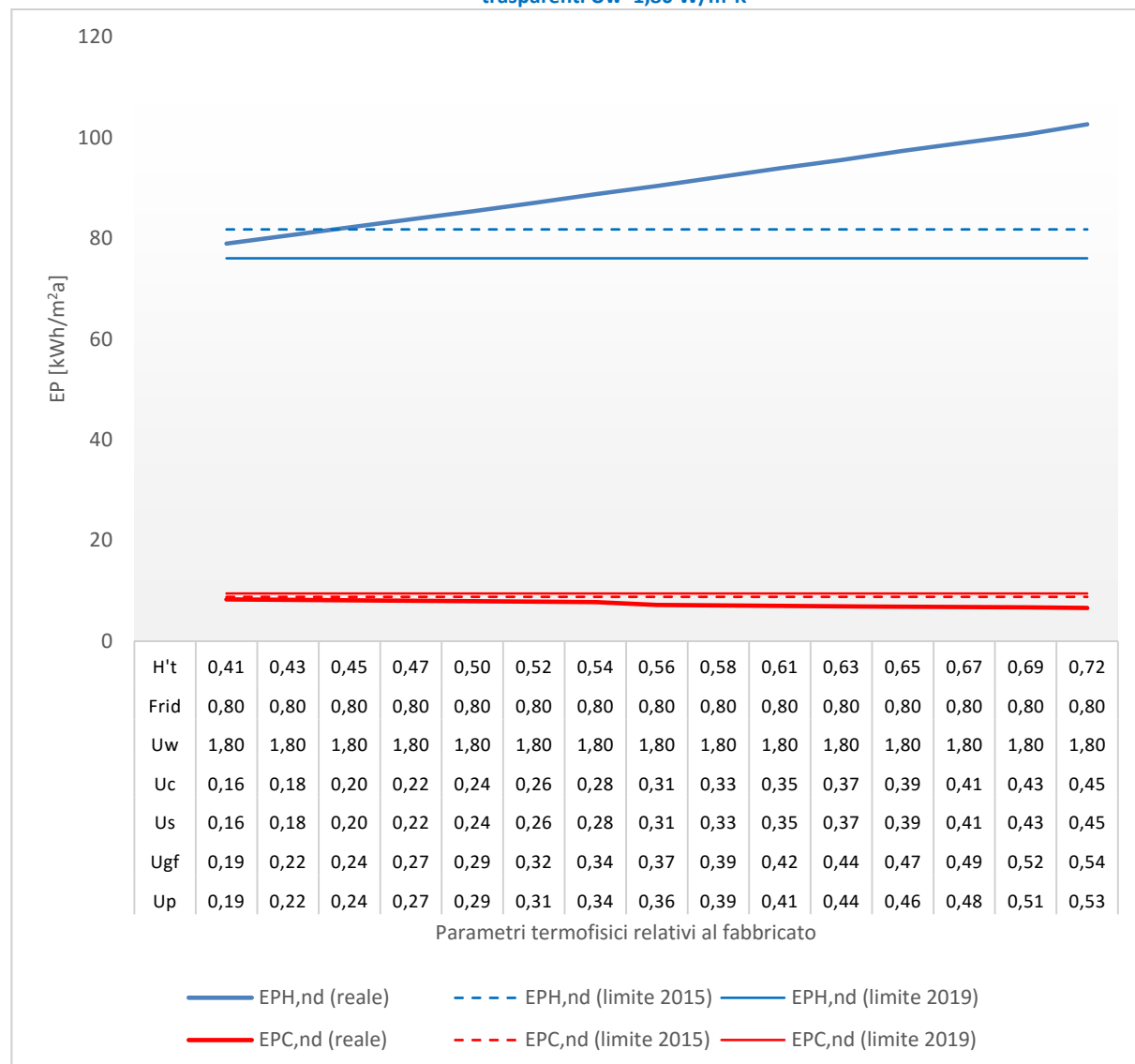
Figura 94 – Edificio ad uso scolastico - Località Torino (Zona climatica E). Variazione di tutti i parametri relativi al fabbricato ad eccezione del fattore di riduzione g_{gl+sh}/g_{gl} = 0,80 e della trasmittanza termica delle chiusure tecniche trasparenti U_w = 1,80 \text{ W/m}^2\text{K}
