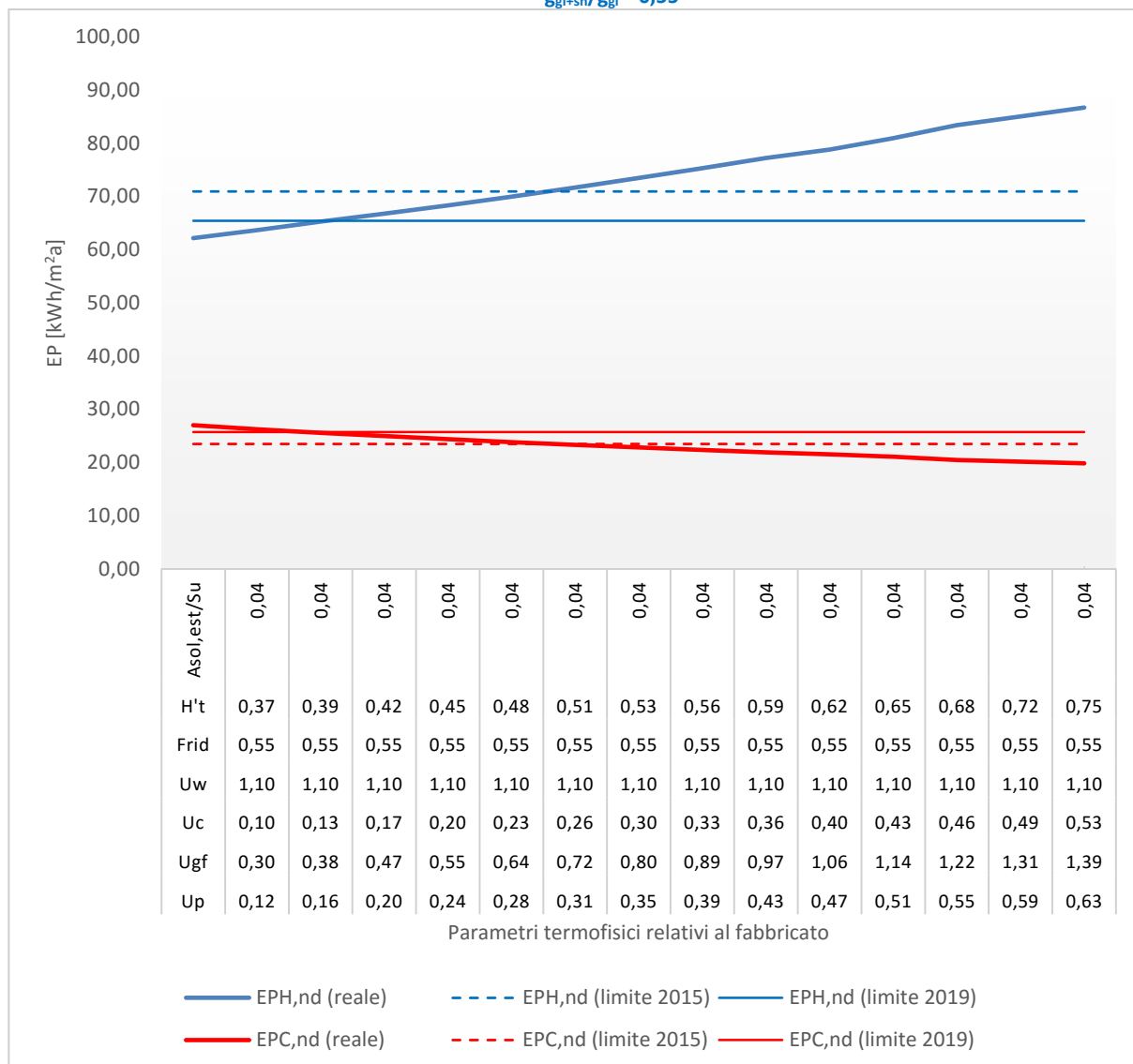
Figura 123 – Palazzina ad uso uffici - Località Torino (Zona climatica E). Variazione di tutti i parametri relativi al fabbricato ad eccezione della trasmittanza termica delle chiusure tecniche trasparenti U_w=1,10 \text{ W/m}^2\text{K} e del fattore di riduzione g_{gl+sh}/g_{gl} = 0,55
