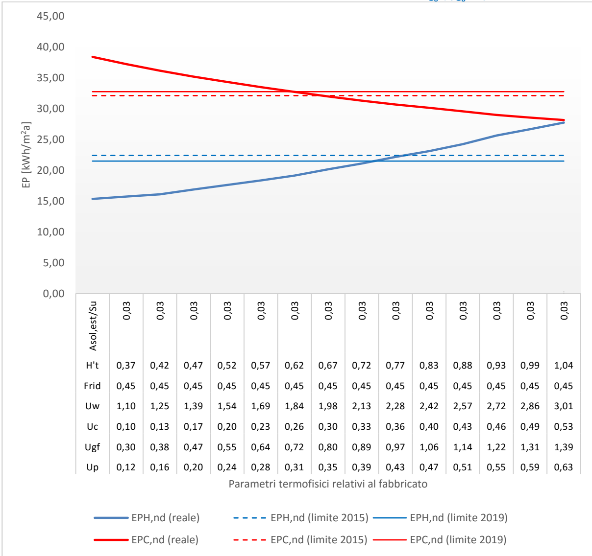
Figura 110 – Palazzina ad uso uffici - Località Palermo (Zona climatica B). Variazione di tutti i parametri relativi al fabbricato dell'edificio ad eccezione del fattore di riduzione g_{gl+sh}/g_{gl} = 0,45
