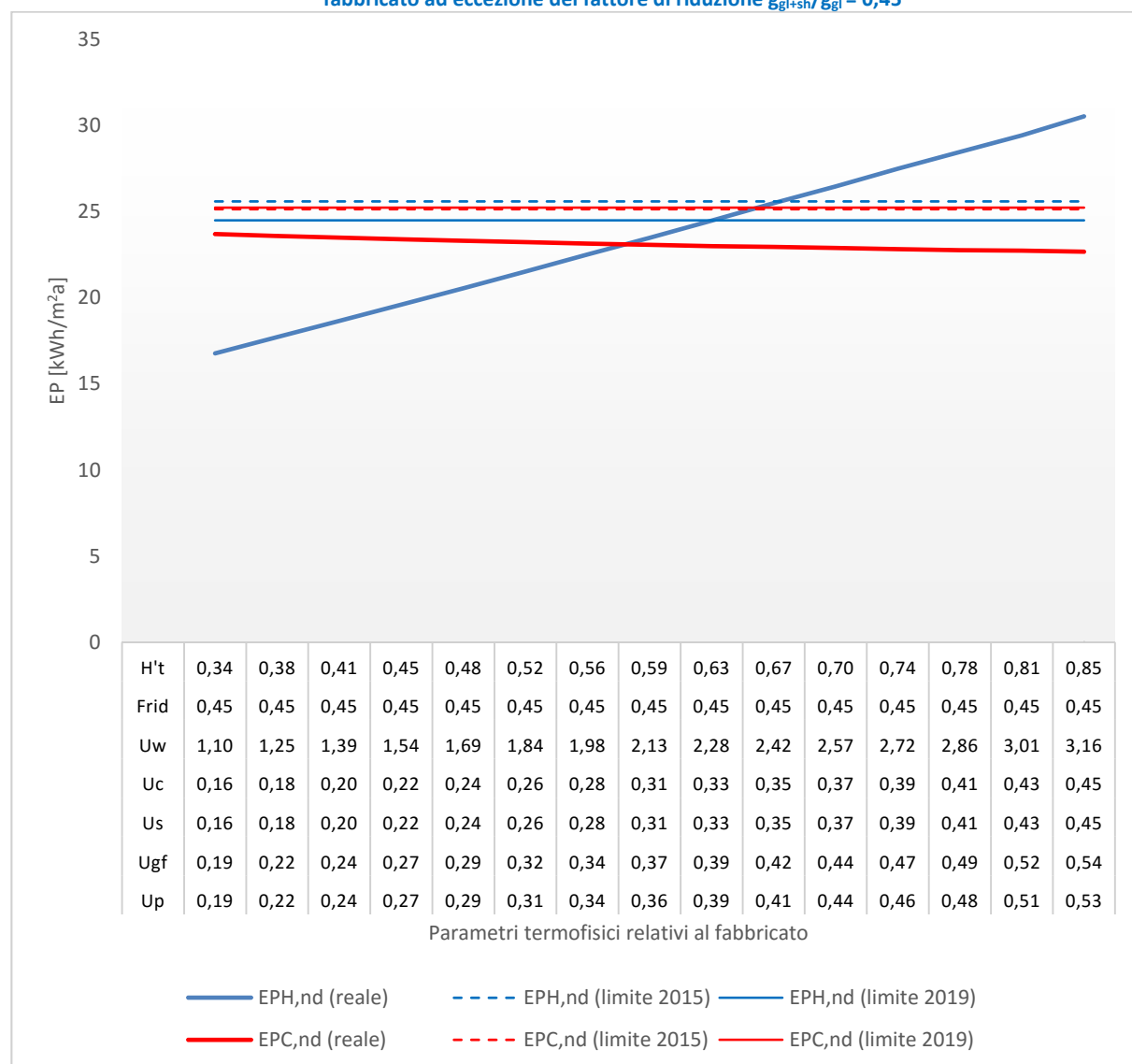
Figura 64 – Edificio ad uso scolastico - Località Palermo (Zona climatica B). Variazione di tutti i parametri relativi al fabbricato ad eccezione del fattore di riduzione g_{gl+sh}/g_{gl} = 0,45
