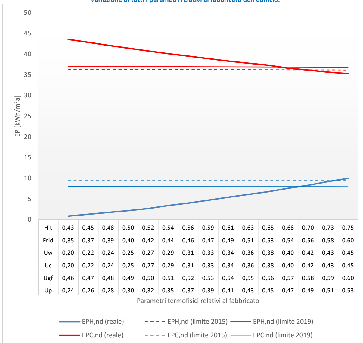
Figura 169 – Palazzina con destinazione d'uso residenziale - Località Palermo (Zona climatica B). Unità Immobiliare U.I.8. Variazione di tutti i parametri relativi al fabbricato dell'edificio.
