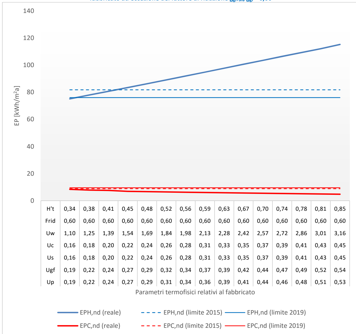
Figura 89 – Edificio ad uso scolastico - Località Torino (Zona climatica E). Variazione di tutti i parametri relativi al fabbricato ad eccezione del fattore di riduzione g_{gl+sh}/g_{gl} = 0,60
