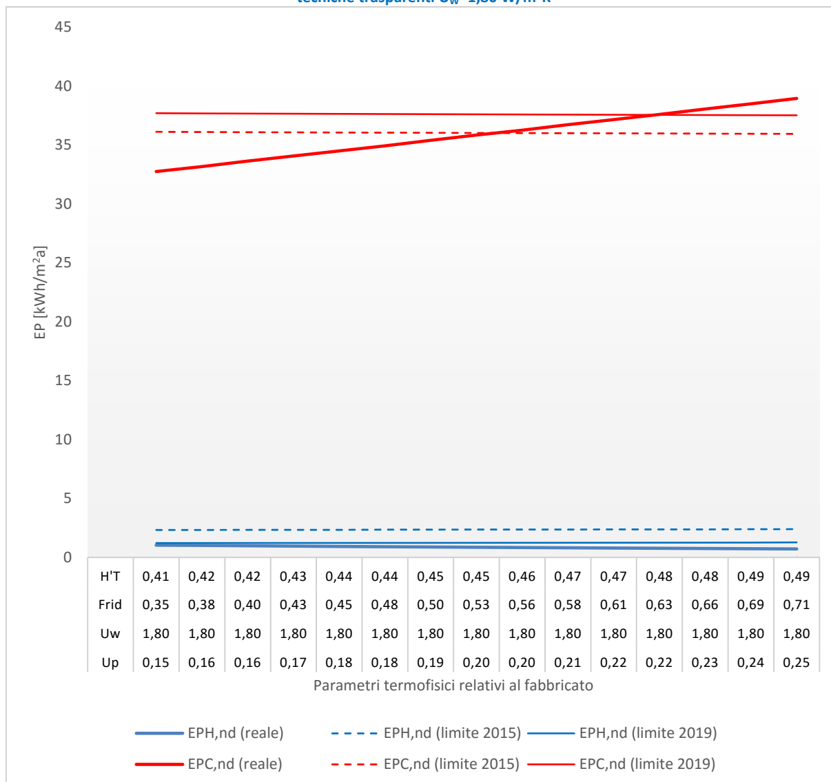
Figura 183 – Palazzina con destinazione d'uso residenziale - Località Roma (Zona climatica D). Unità Immobiliare U.I.4. Variazione di tutti i parametri relativi al fabbricato dell'edificio ad eccezione della trasmittanza termica delle chiusure tecniche trasparenti U_w=1,80 \text{ W/m}^2\text{K}
