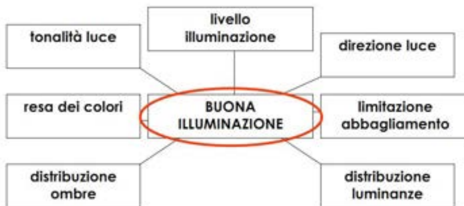
Figura 2.6. Parametri coinvolti nella progettazione illuminotecnica [12]
