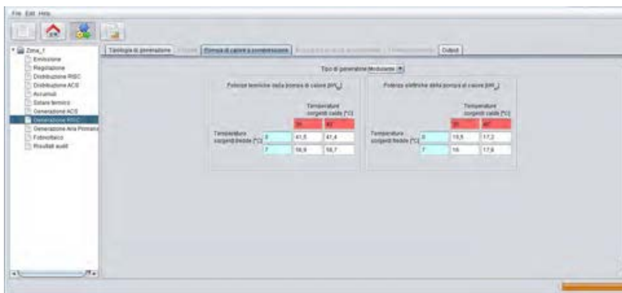
Figura 60: Caratteristiche della pompa di calore dell'intervento 6a.
