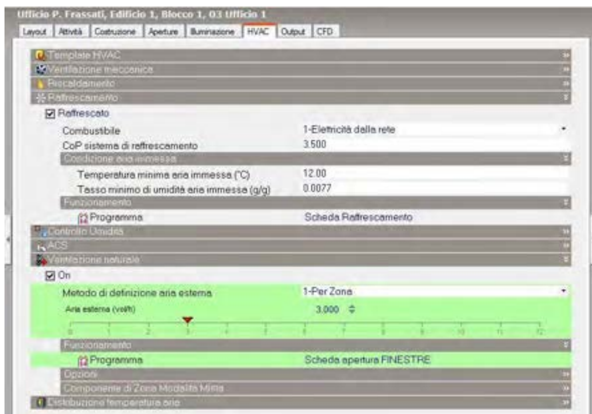
Figura 51. Design Builder: scheda "HVAC" per l'Ufficio 1
