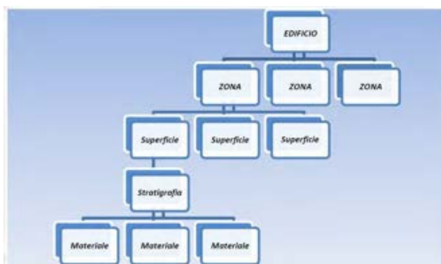
Figura 36. Schema della costruzione del modello di edificio
