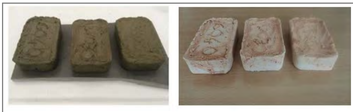
Figura 14. Campioni di argilla e fly ash prima (sinistra) e dopo (destra) il processo di sinterizzazione.
