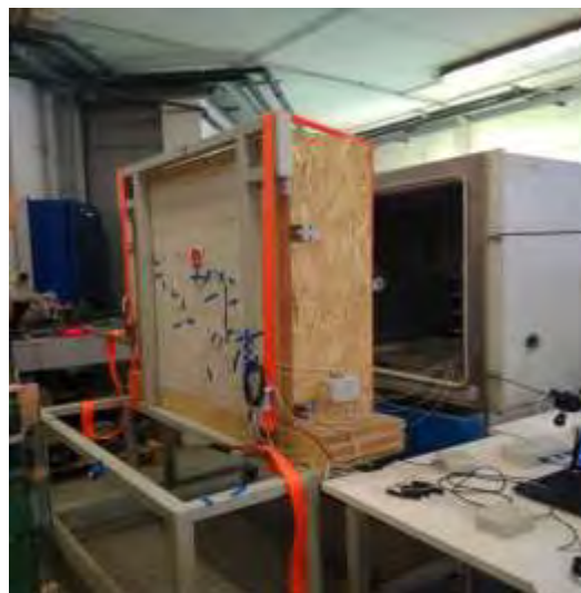
Figura 8: Posa del kit termoflussimetrico faccia interna
