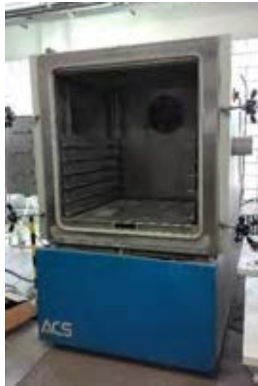
Figura 2: Camera climatica utilizzata (Angelantoni 2100 CH)
