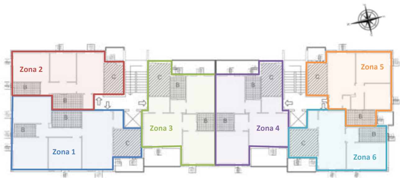
Figura 2.5. Individuazione delle zone termiche.
