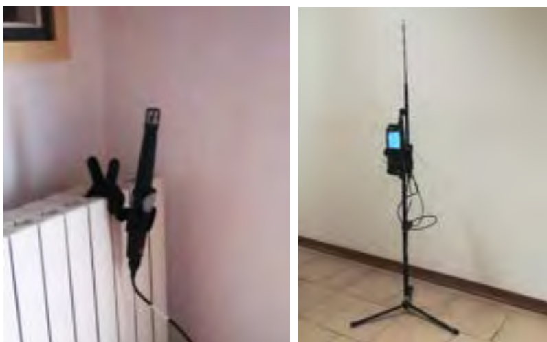
Figura 31. A sinistra: sonda per la misura della temperatura interna (punto B). A destra: centralina di acquisizione
