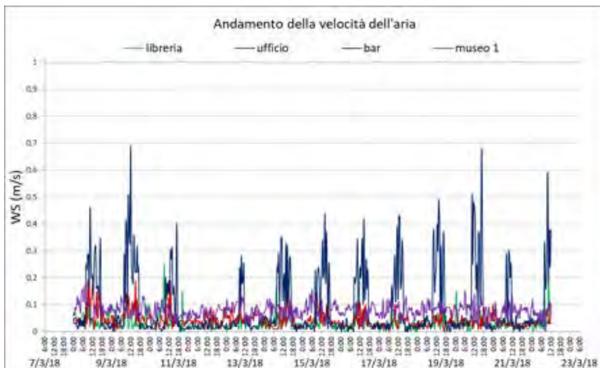
Figura 5.3.9. Andamento della velocità nei locali del museo del Carbone - 08-19 mar 2018.
