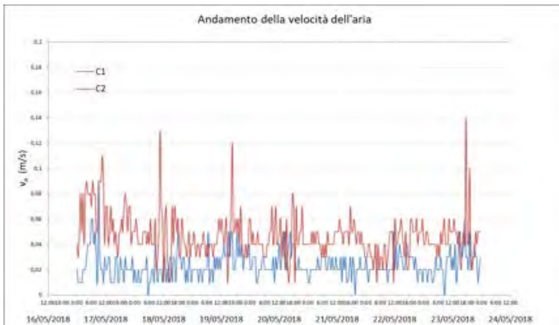
Figura 4.8.6. Profilo di velocità dell'aria interna della sala Mostre – 17/5/18 – 24/5/18.
