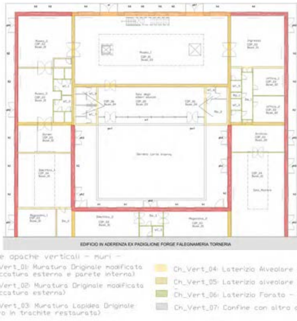
Figura 49. Planimetria con indicazione delle strutture dell'involucro Museo PAS
