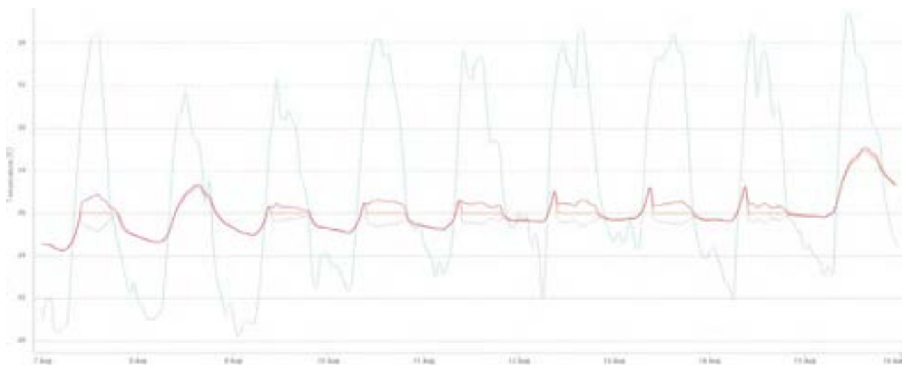
Figura 40. Andamento temperature (aria esterna, aria interna, superfici, operante) nella settimana tipo estiva (da sabato a sabato) dell'ingresso
