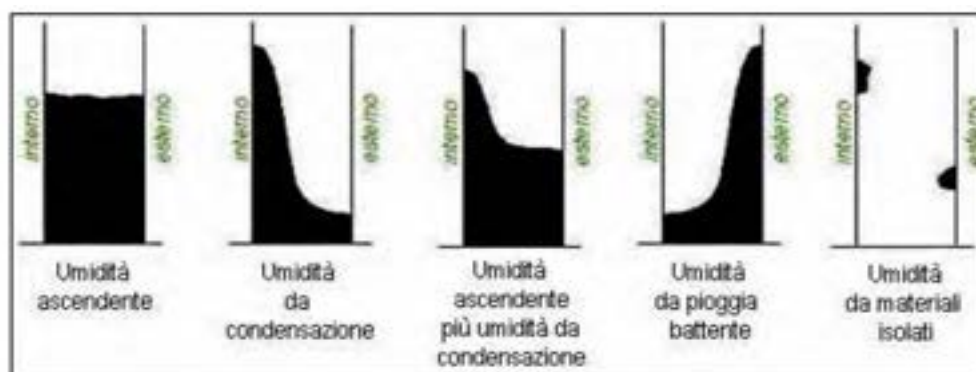
Figura 54 distribuzione della umidità per tipo di causa
