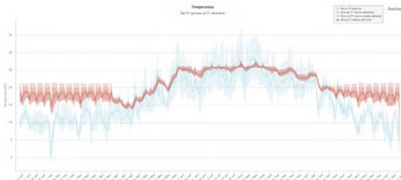
Figura 5. Esempio di Andamento annuale delle temperature interne ed esterna in presenza di impianti di climatizzazione.
