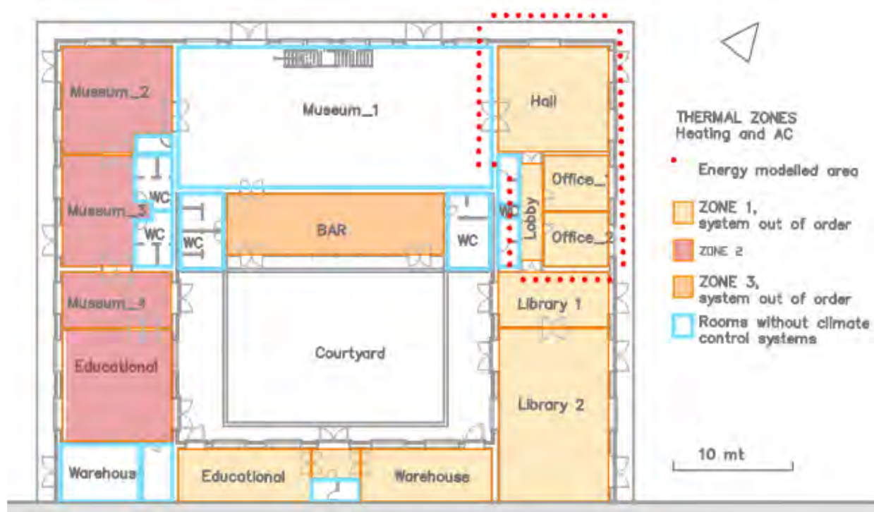
Figura 32. Articolazione planimetrica delle zone termiche
