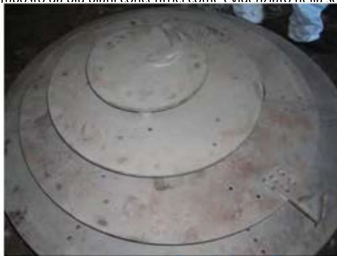
Figura 2.5. Parte esterna della griglia del gassificatore.
