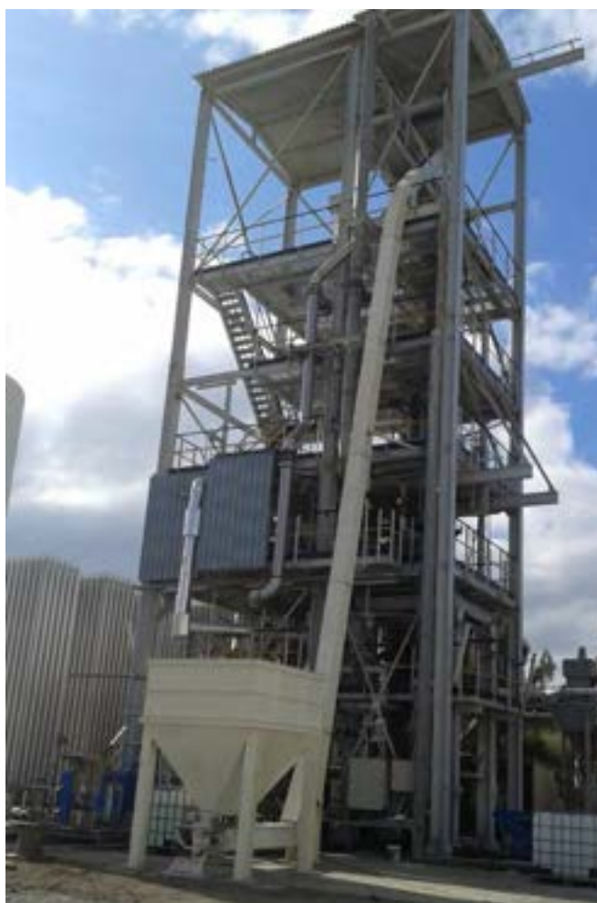
Figura 3.3.1.1. Sistema di caricamento automatico del combustibile (redler).
