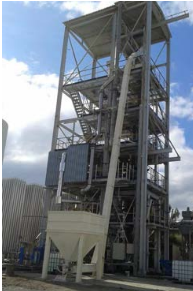
Figura 2.3. Sistema di caricamento automatico del combustibile (redler).
