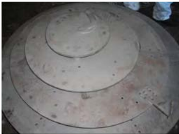
Figura 3.3.1.3. Parte esterna della griglia del gassificatore.
