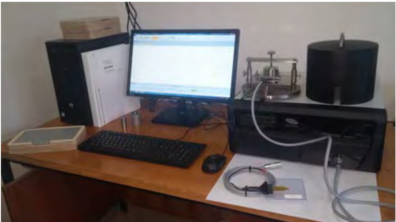
Figura 35. Sistema HotDisk TPS500S installato presso i laboratori ENEA. Setup sperimentale per le misure di conducibilità termica
