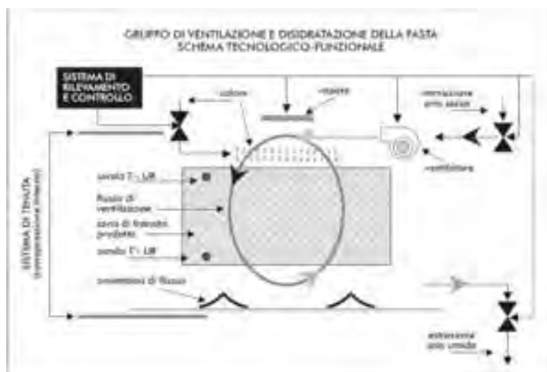
Figura 11. Schema funzionale di un gruppo di ventilazione all'interno di un essiccatore
