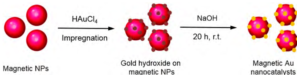
Figura 3.1.3. Nanosistema a base oro supportato su magnetite sviluppato mediante impregnazione di precursori dell'oro su magnetite e successive reazioni di riduzione
