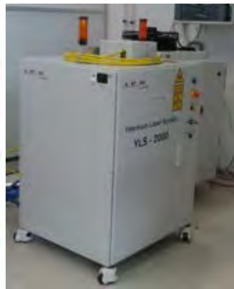
Figura 16: sorgente laser in fibra e schema di uno dei suoi moduli
