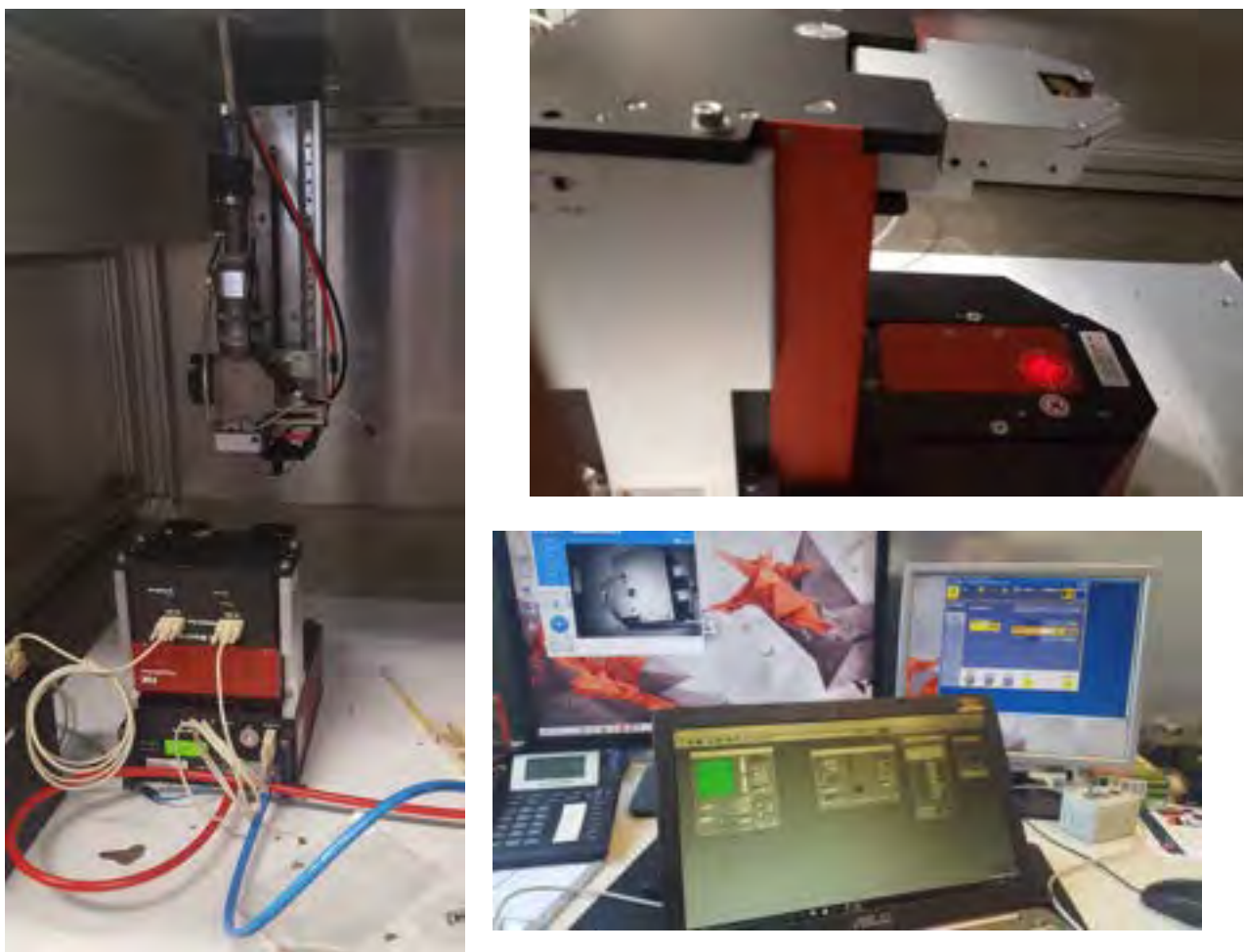
Figura 21: Set up di misura contemporanea di potenza e qualità del fascio (fasi di collaudo presso PRIMES)
