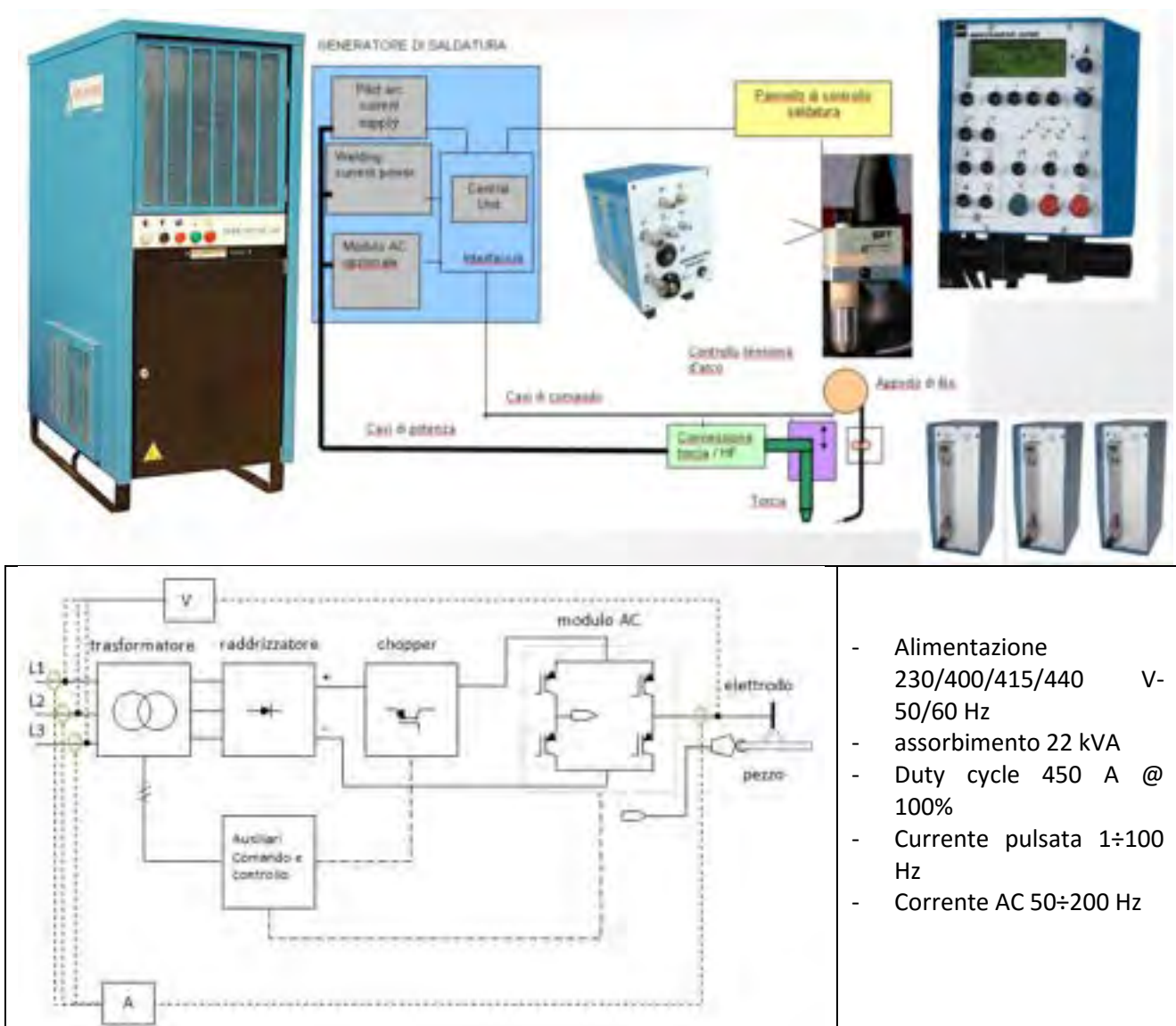
Figura 13- Schema di funzionamento del generatore TIG NERTAMATIC 450
