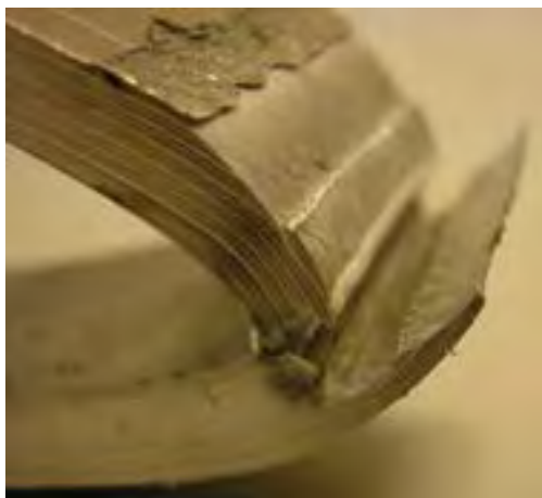
Figura 18 Provino di piega 00-P21 – rottura per sfaldamento/scollatura
