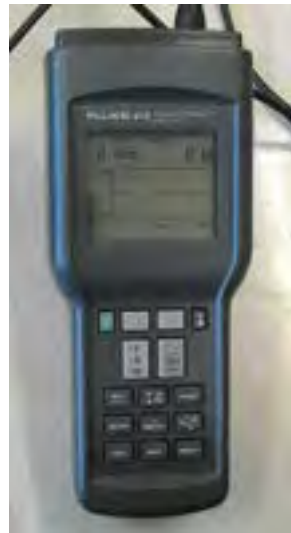
Fig. 12 Wattmetro elettronico digitale Fluke – modello 418
