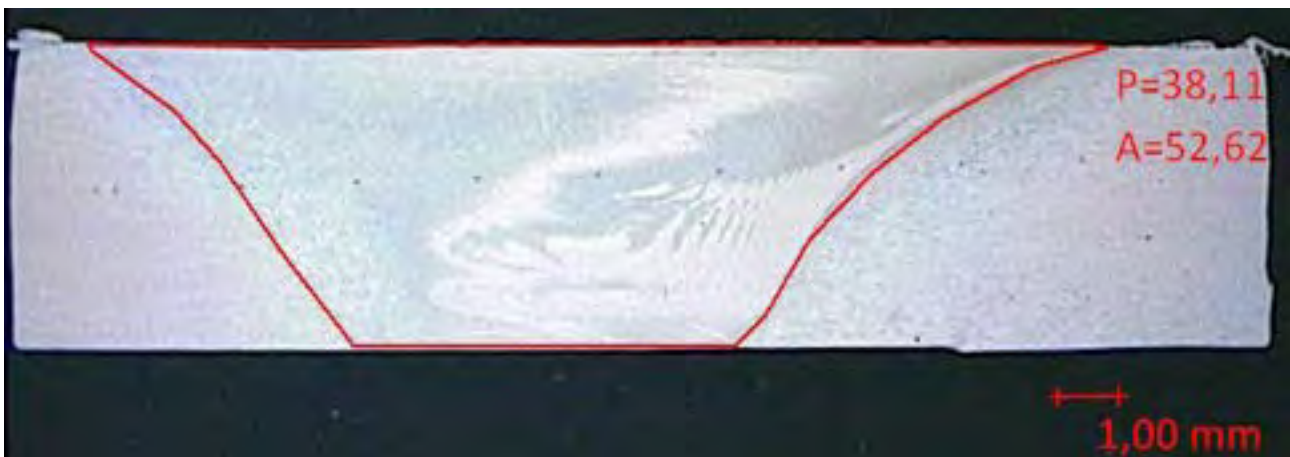
Fig. 24 Esempio di misura della zona plasticizzata
