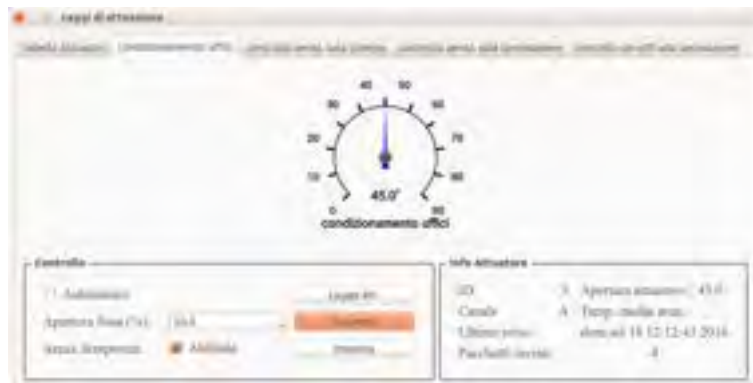
Figura 5: esempio di attuazione in cui l'inclinazione di una griglia di aerazione viene impostata al valore desiderato di 45°
