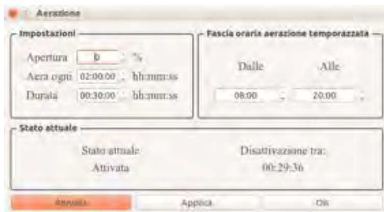
Figura 5: esempio di attuazione in cui l'inclinazione di una griglia di aerazione viene impostata al valore desiderato di 45°
