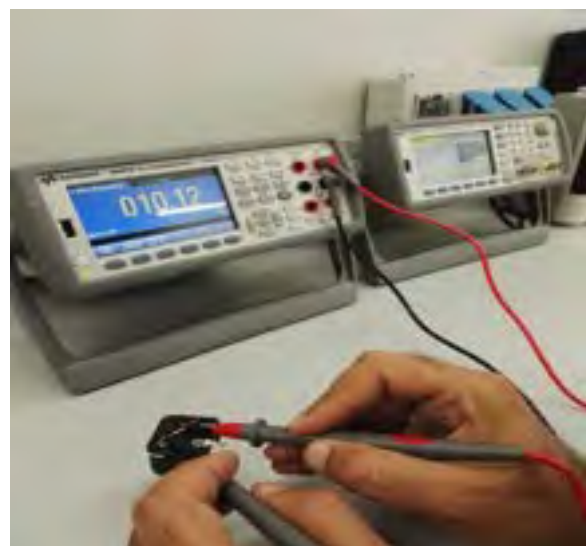
Figura 31 Set-up di misura (a sinistra) e preventiva misura della resistenza di sensing (a destra).
