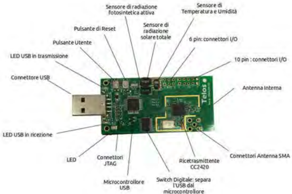
Figura 41 TelosB: sensori, attuatori e interfacce.
