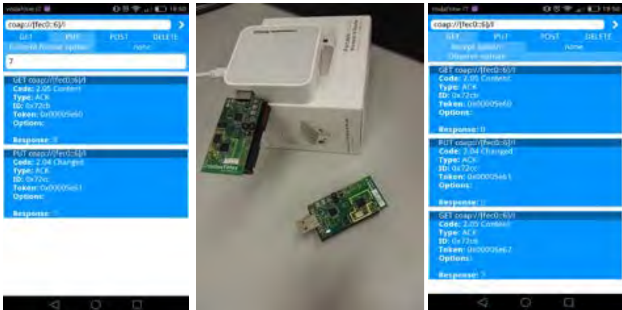
Figura 49 Esecuzione di GET e PUT mediante Aneska.
