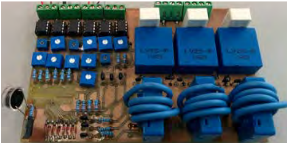
Figura 36 Prototipo Sensor board vista dall'alto.
