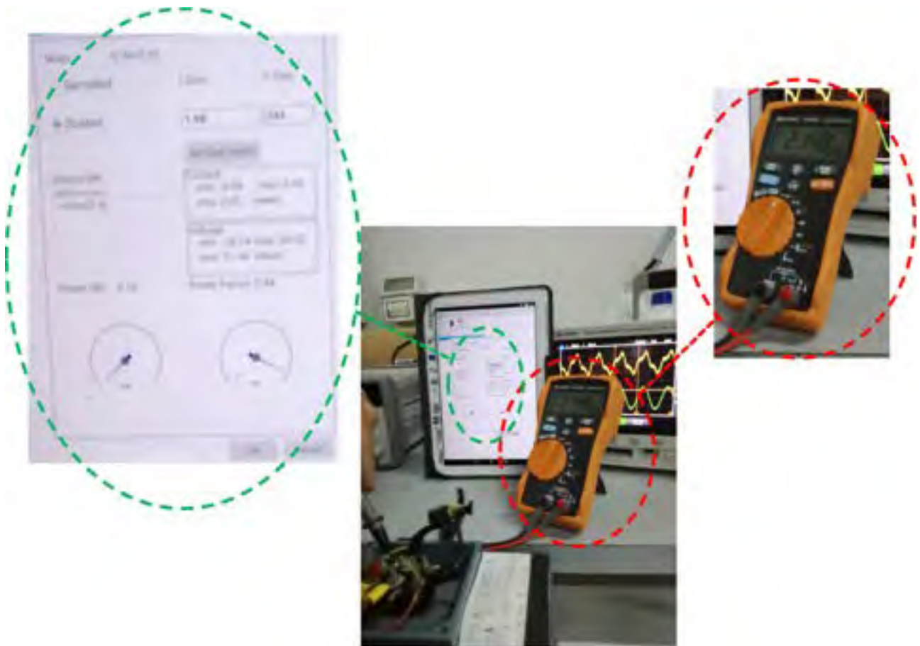
Figura 77 Misura di tensioni e correnti di fase.
