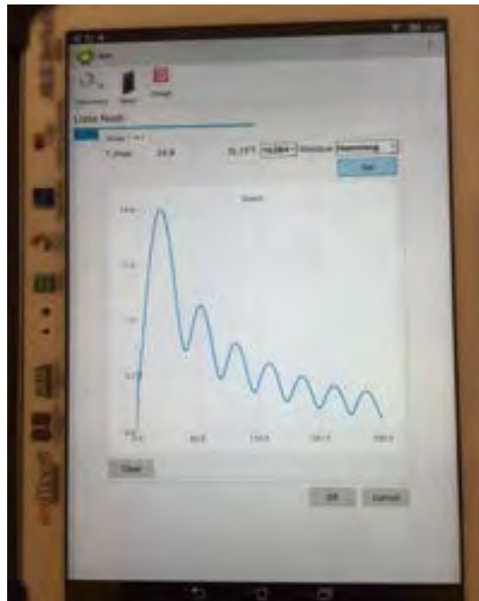
Figura 71 Risultato di un'analisi spettrale mediante la App finalizzato alla misura della velocità di rotazione.
