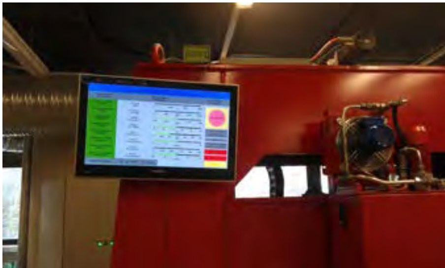
Fig. 7 – Monitor per la visualizzazione in tempo reale dei parametri di saldatura
