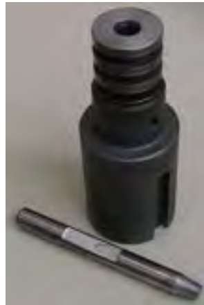
Fig. 6 – Utensile FSW scomponibile
