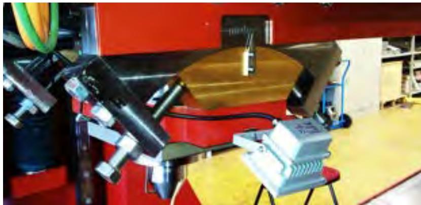
Fig. 4 – Sistema di regolazione dell'angolo di tilt
