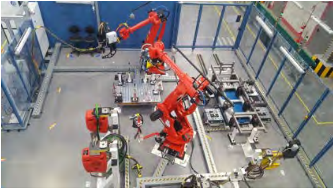
Figura 27: Sistemi robotizzati di saldatura che simulano i sistemi in produzione degli stabilimenti FCA: processi di saldatura “Cold Metal Arc Welding” (particolare processo GMAW); laser (Fibra/Diodo); resistenza RSW e Spot Friction Stir Welding SFSW.
