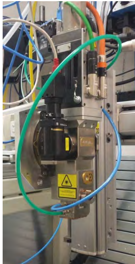
Figura 12: Set UP misure efficienza laser (SX); Sistema di variazione fuoco asse Z (DX)
