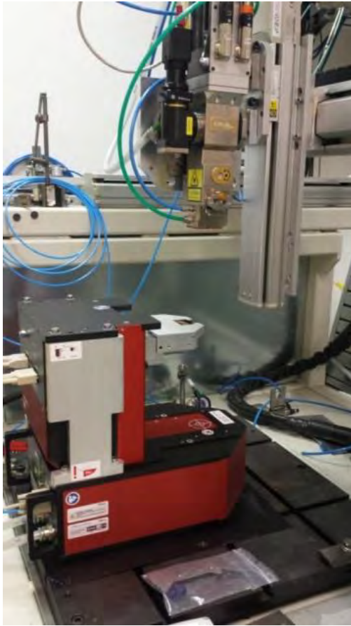
Figura 12: Set UP misure efficienza laser (SX); Sistema di variazione fuoco asse Z (DX)
